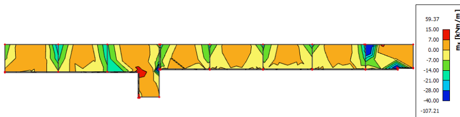
Slika 11.79 Prikaz momenata savijanja – mx
