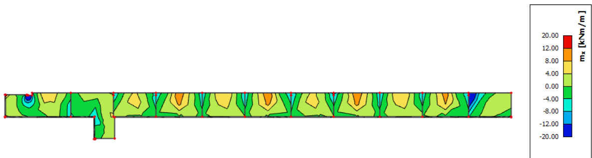
Slika 11.39 Prikaz momenata savijanja – mx
