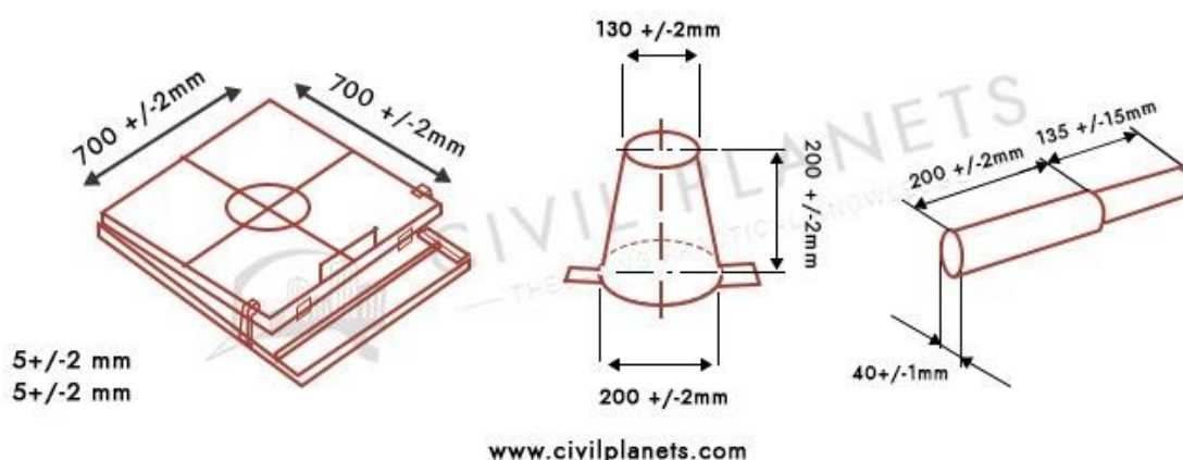
Slika 3.2. Oprema za ispitivanje rasprostiranja betona [13]
