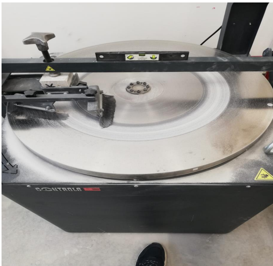
Slika 7.9. Uređaj za ispitivanje habanja-Bohmeov disk
