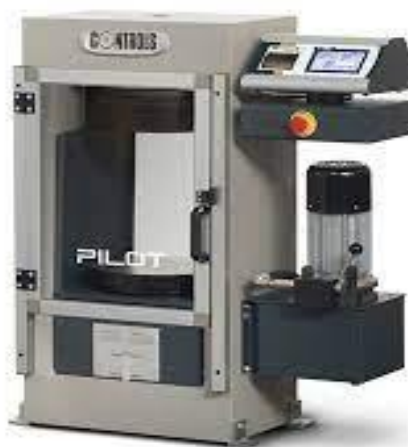
Slika 4.1. Uređaj za ispitivanje karakteristične tlačne čvrstoće
