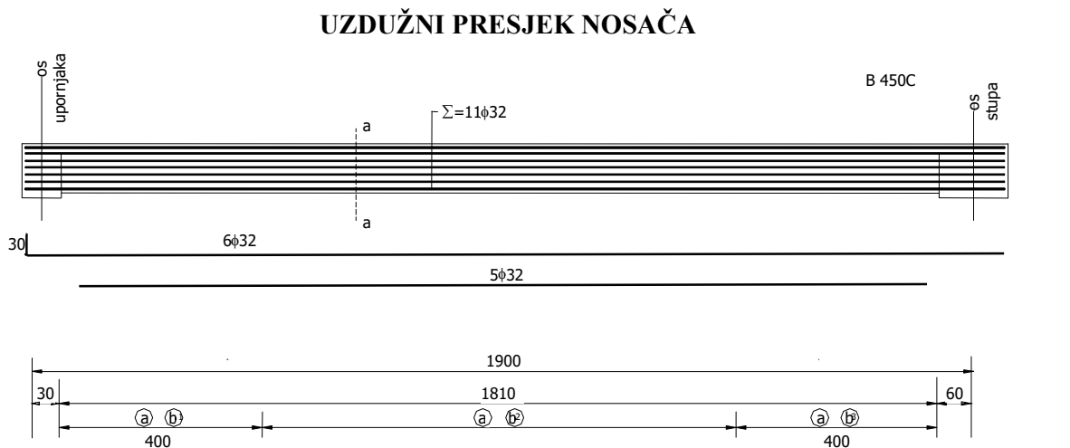
Slika 32. Prikaz armiranja uzdužnog nosača u polju
