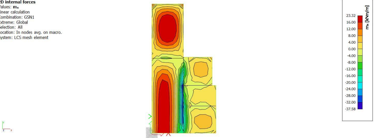
Slika 6.14 Moment savijanja M_{Ed,x} (kNm/m) za GSN-1
