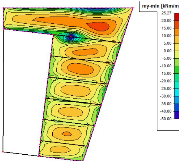
Slika 57:  $My_{min}$  za kombinaciju GSU
