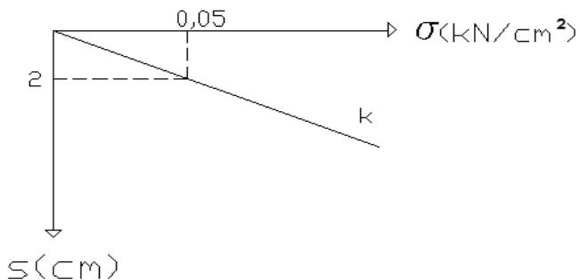
Slika 14: Dijagram odnosa naprezanja u tlu i slijeganja
