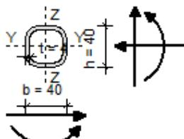
Proračunski profil vertikala poprečne rešetke je  $30 \times 30 \times 3$ . Profil je povećan na  $40 \times 40 \times 4$  zbog izvedbe spojeva, mogućnosti varenje (stijenka  $> 4 \text{ mm}$ ) i predviđene reklame duž cijelog objekta koja se oslanja na Poprečnu rešetku 1, a njen utjecaj nije uzet u obzir ovim proračunom.
