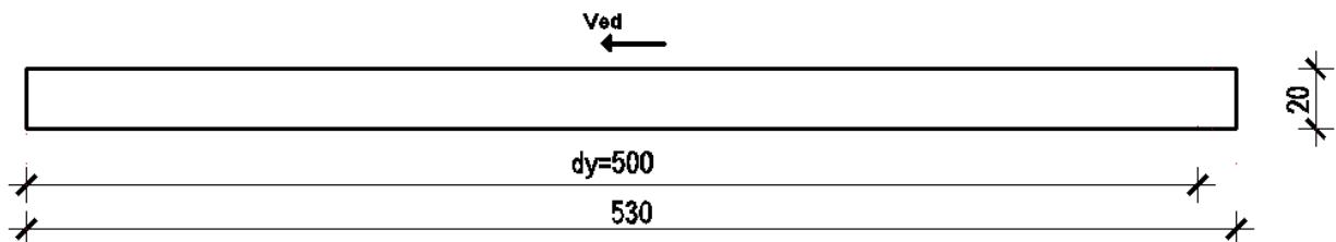
Slika 86: Skica poprečnog presjeka zida
