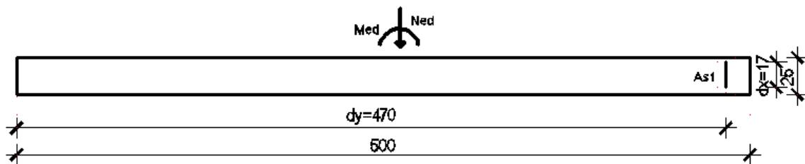
Slika 74: Skica poprečnog presjeka zida
