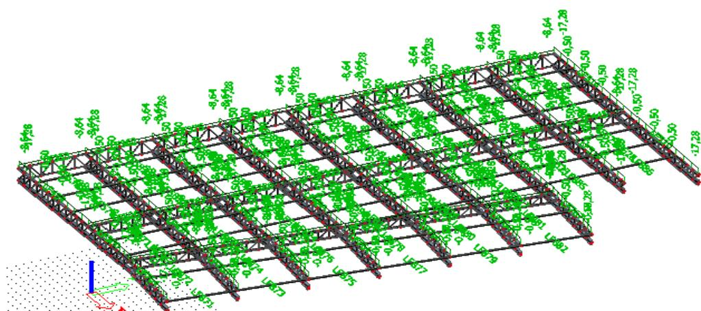
Slika 8: Prikaz raspodjele dodatnog stelnog opterećenja
