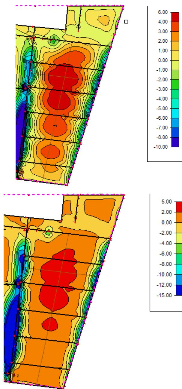
Slika 39: Armatura  $M_x$  max i min za poziciju 103
