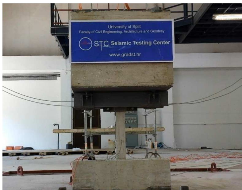
Slika 3.57 Izgled karakterističnog stupa prije ispitivanja
