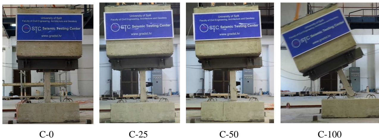
Slika 3.81 Izgled stupova nakon završetka testova
