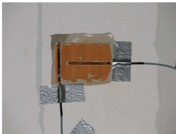
Slika 3.12. Prikaz zalijepljene mjerne trake na žiđe
