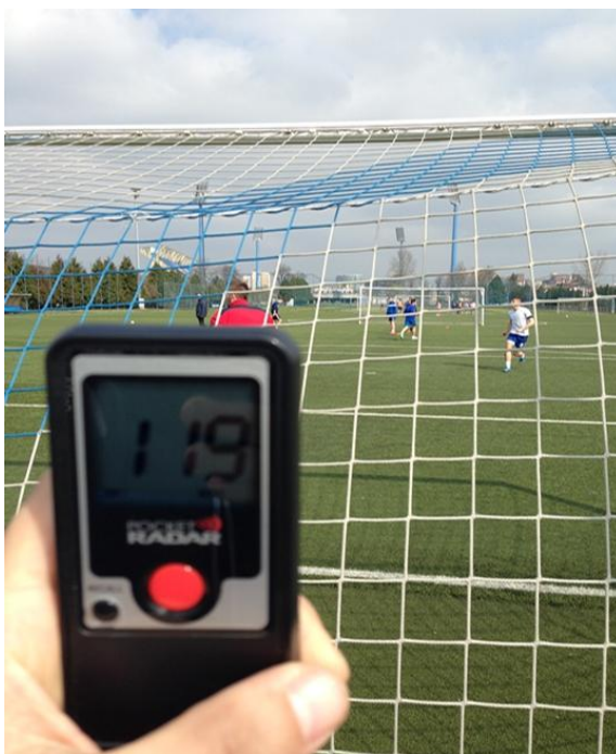
Slika 7. Pocket radar mjeri brzinu udarca u km/h
