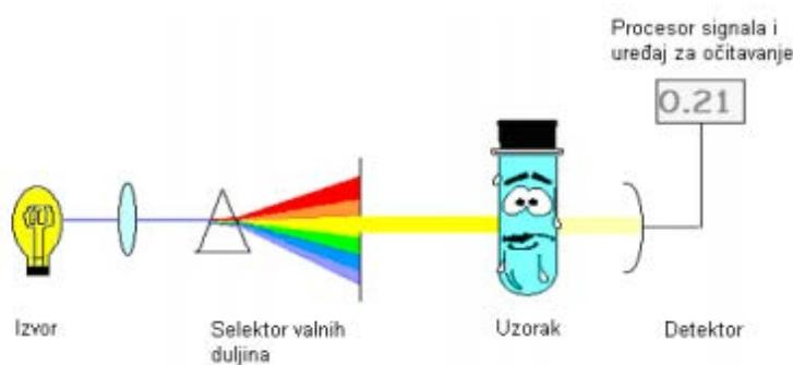
Slika 1. Shematski prikaz dijelova spektrofotometra
