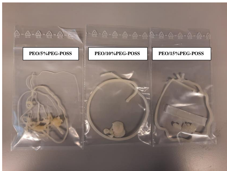
Slika 14. Uzorci nakon hlađenja (PEO/PEG-POSS)
