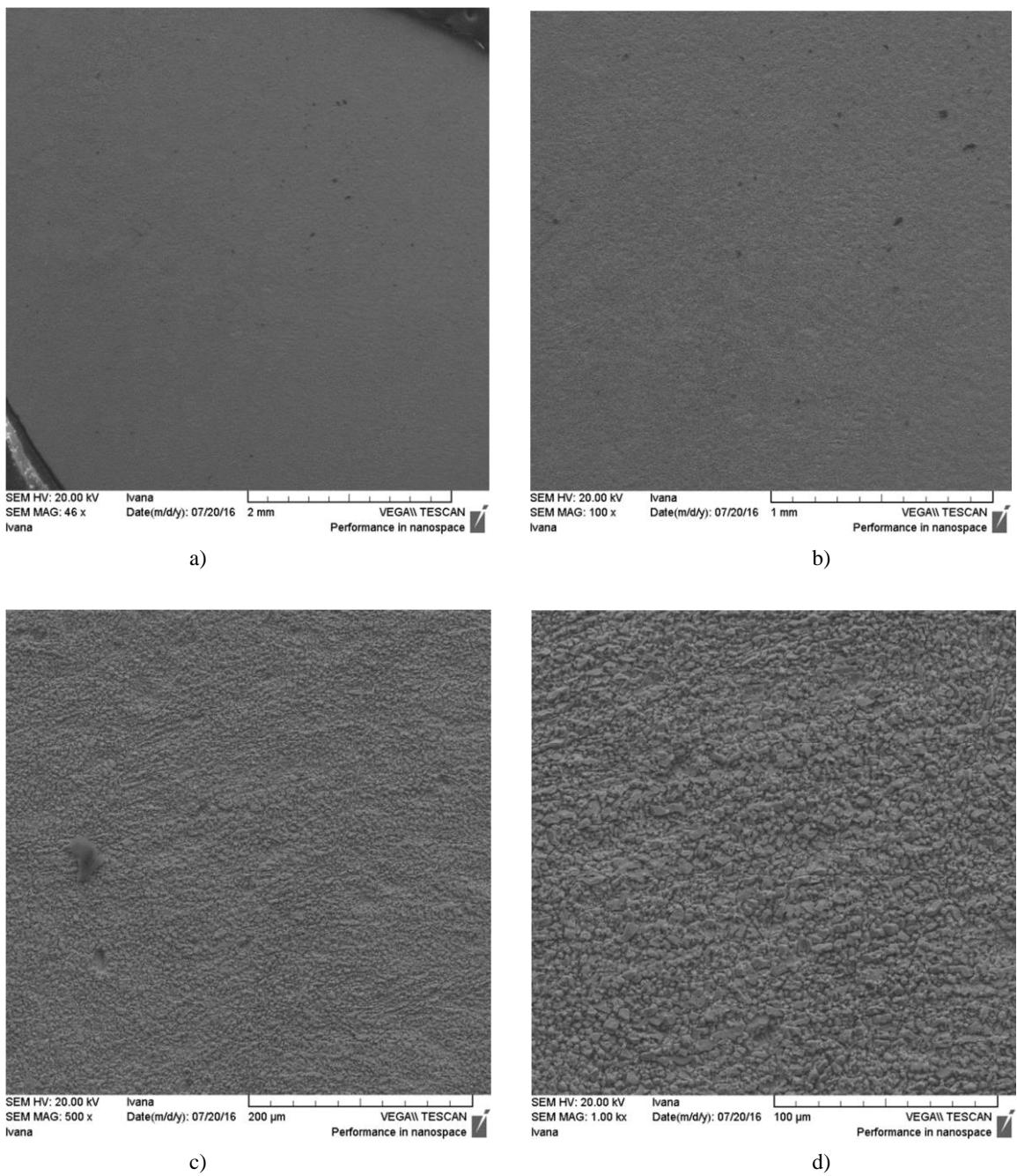
**Slika 29.** SEM snimke površine uzorka CuAlNi legure nakon potenciodinamičkog polarizacijskog mjerjenja u 0.1 % NaCl otopini uz uvećanja od a) 46 puta; b) 100 puta; c) 500 puta i d) 1000 puta
