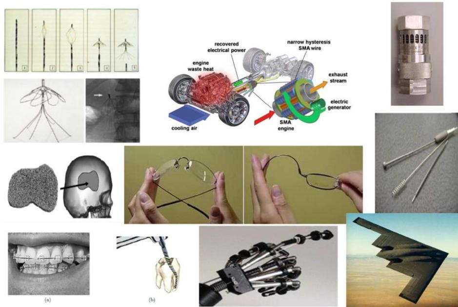
**Slika 12.** Primjeri primjene legura s prisjetljivosti oblika
