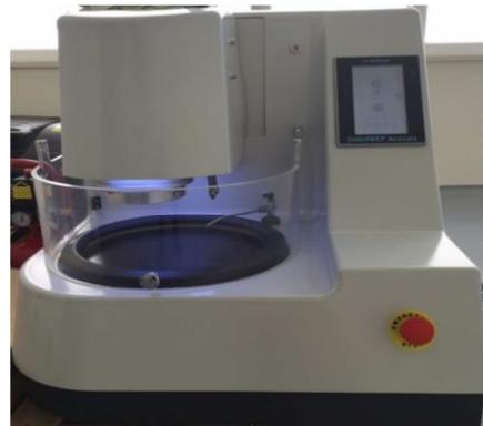
Slika 20. Uređaj za brušenje i poliranje
