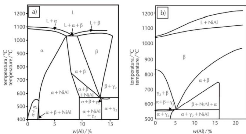
**Slika 10.** Ternarni fazni dijagrami legure CuAlNi vertikalni presjek pri  $w(\text{Ni}) = 3\%$  (a) i vertikalni presjek pri  $w(\text{Al}) = 14\%$  (b)<sup>23</sup>
