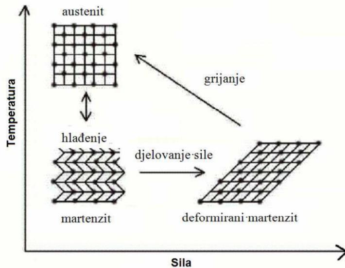
Slika 3. Ciklus promjena strukture SMA legure<sup>11</sup>
