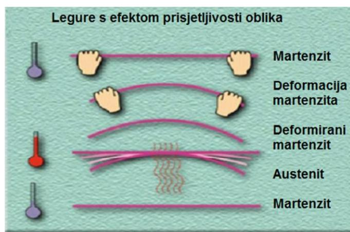
Slika 4. Shematski prikaz promjena oblika pod utjecajem temperature<sup>12</sup>
