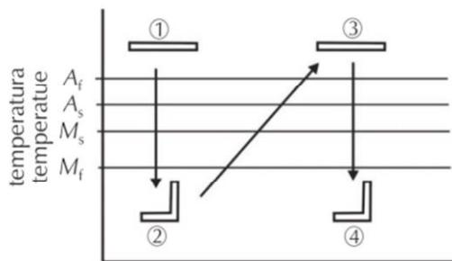
**Slika 9.** Shematski prikaz dvostrukog efekta prisjetljivosti oblika<sup>21</sup>
