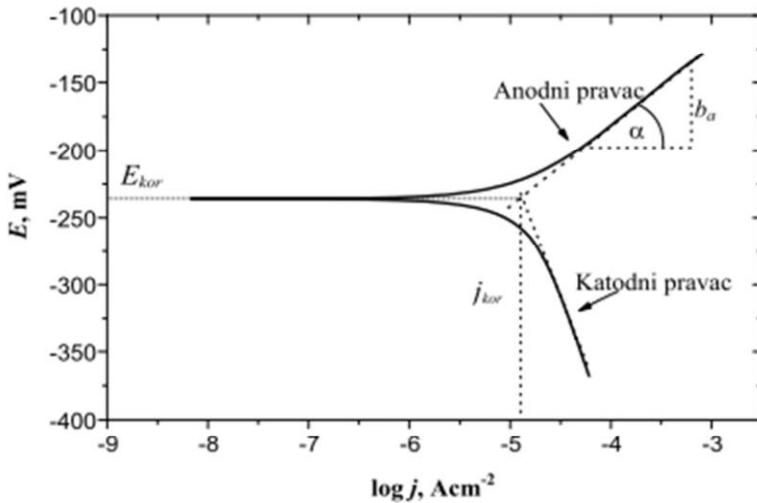
**Slika 17.** Tafelova metoda određivanja korozijskih parametara iz polarizacijskih mjerena
