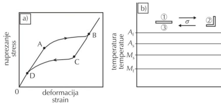
**Slika 7.** Dijagram naprezanje- deformacija legure s prisjetljivosti oblika a) i shematski prikaz pseudoelastičnosti b)<sup>21</sup>
