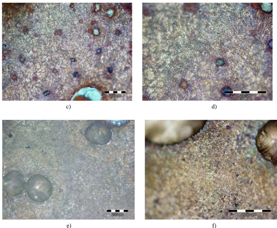
**Slika 28.** Površina CuAlNi elektrode nakon polarizacijskog mjerena u 0.1 % NaCl otopini a) i b); u 0.9 % NaCl otopini c) i d) i u 1.5 % otopini e) i f).
