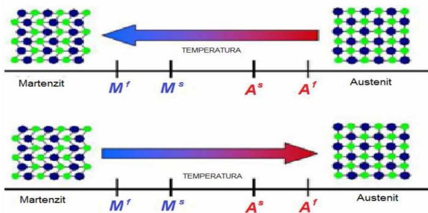
**Slika 5.** Temperaturno inducirane fazne transformacije SMA legura bez djelovanja mehaničke sile s označenim karakterističnim temperaturama fazne transformacije<sup>17</sup>
