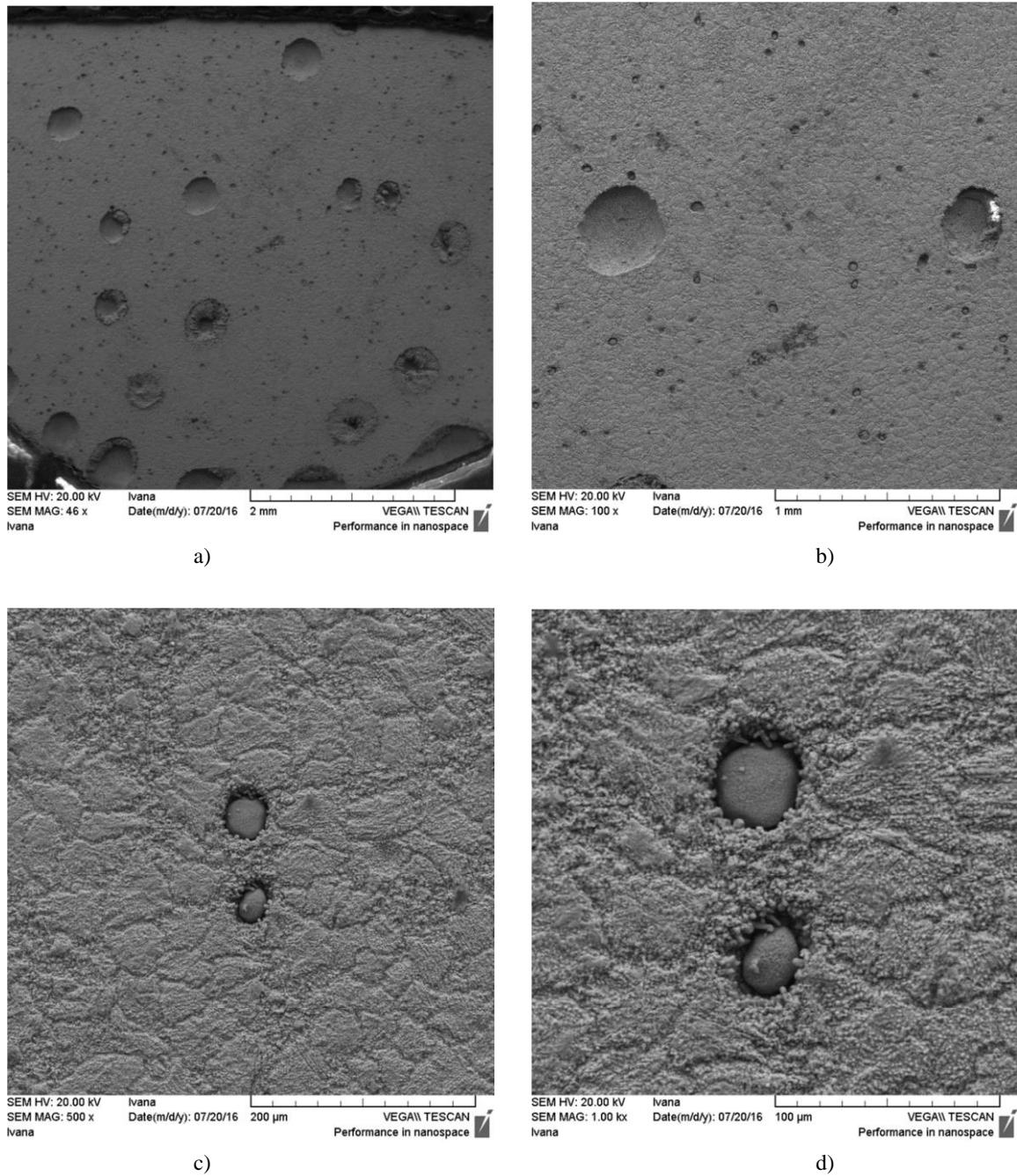
**Slika 31.** SEM snimke površine uzorka CuAlNi legure nakon potenciodinamičkog polarizacijskog mjerjenja u 0.9 % NaCl otopini uz uvećanja od a) 46 puta; b) 100 puta; c) 500 puta i d) 1000 puta
