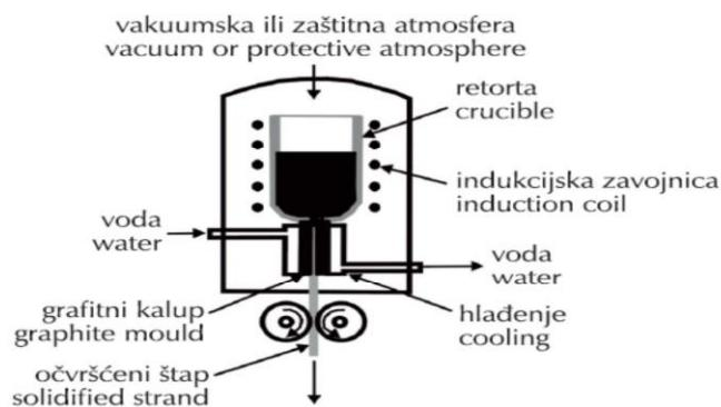
**Slika 11.** Shematski prikaz lijevanja legure CuAlNi tehnologijom vertikalnog lijevanja<sup>33</sup>
