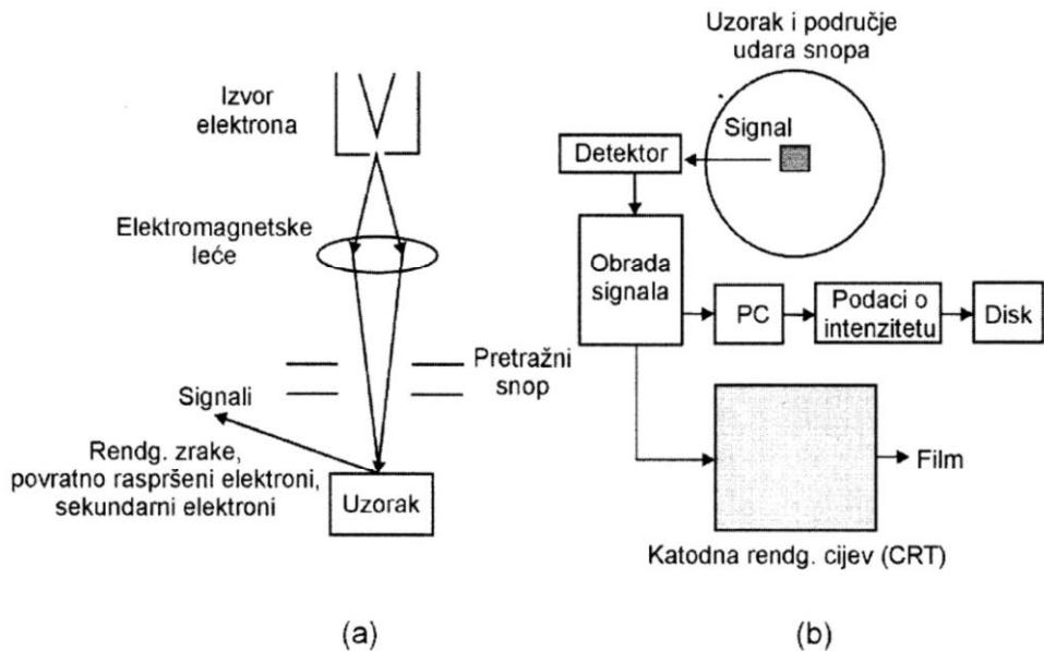
**Slika 19.** Shematski prikaz pretražnog elektronskog mikroskopa: a) nastanak elektronskog snopa i fokusiranje u točku na površini uzorka; b) pojačavanje detektiranih signala za različite analize.<sup>57</sup>
