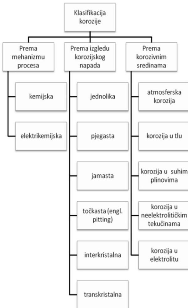
**Slika 13.** Klasifikacija korozije<sup>9</sup>
