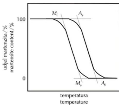
**Slika 6.** Shematski prikaz karakterističnih temperatura martenzitne transformacije i temperaturne histereze<sup>18</sup>
