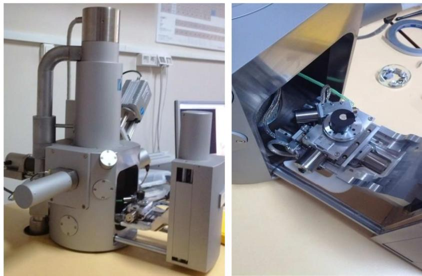
**Slika 23.** Pretražni elektronski mikroskop Tescan Vega TS5136LS
