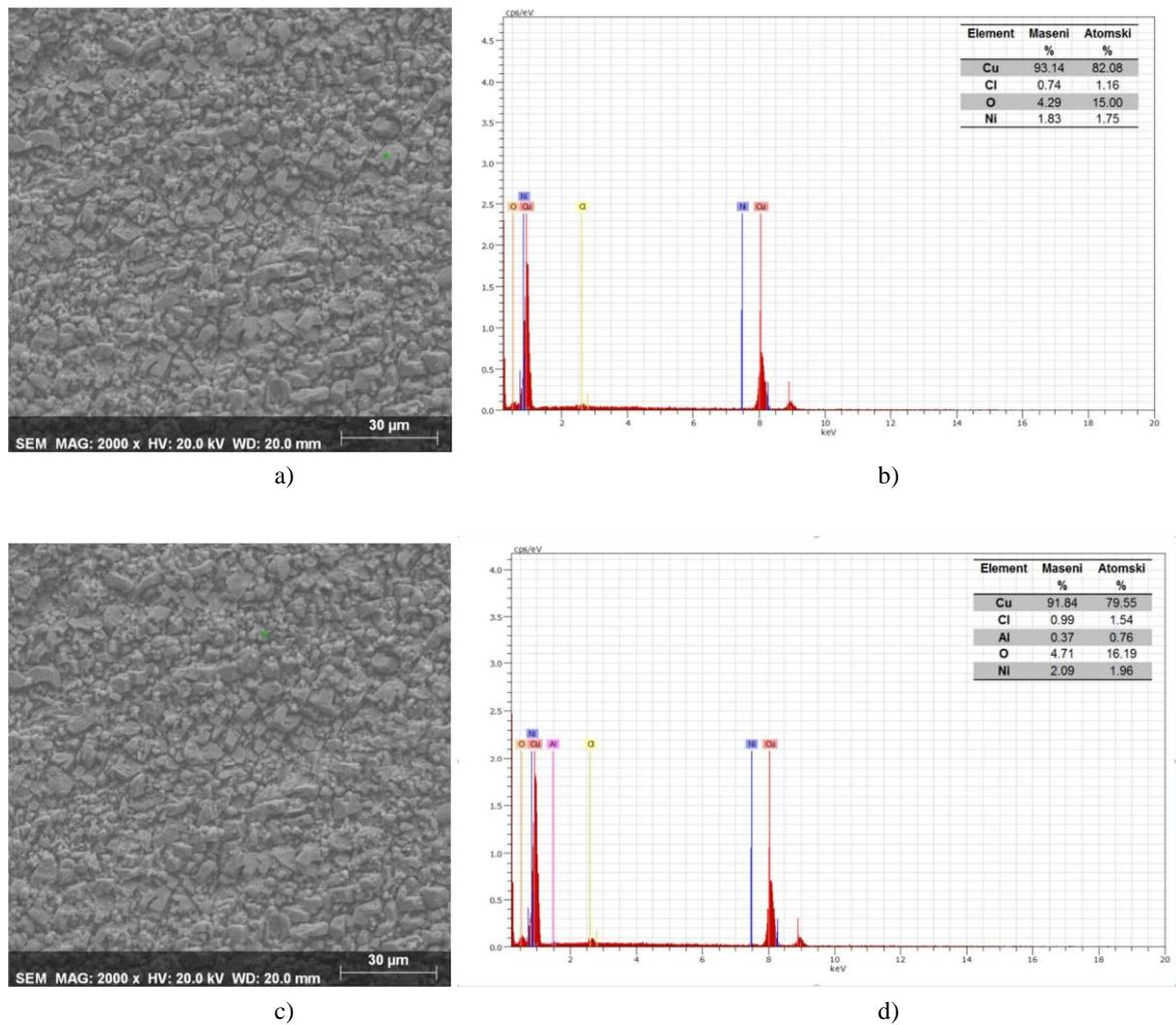
**Slika 30.** SEM snimka površine uzorka CuAlNi legure nakon potenciodinamičkog polarizacijskog mjerena u 0.1 % NaCl otopini (uvećanje 2000 puta) i pripadajuća EDS analiza
