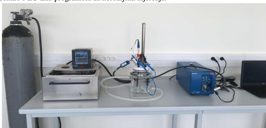
**Slika 22.** Aparatura za provedbu elektrokemijskih mjerena
