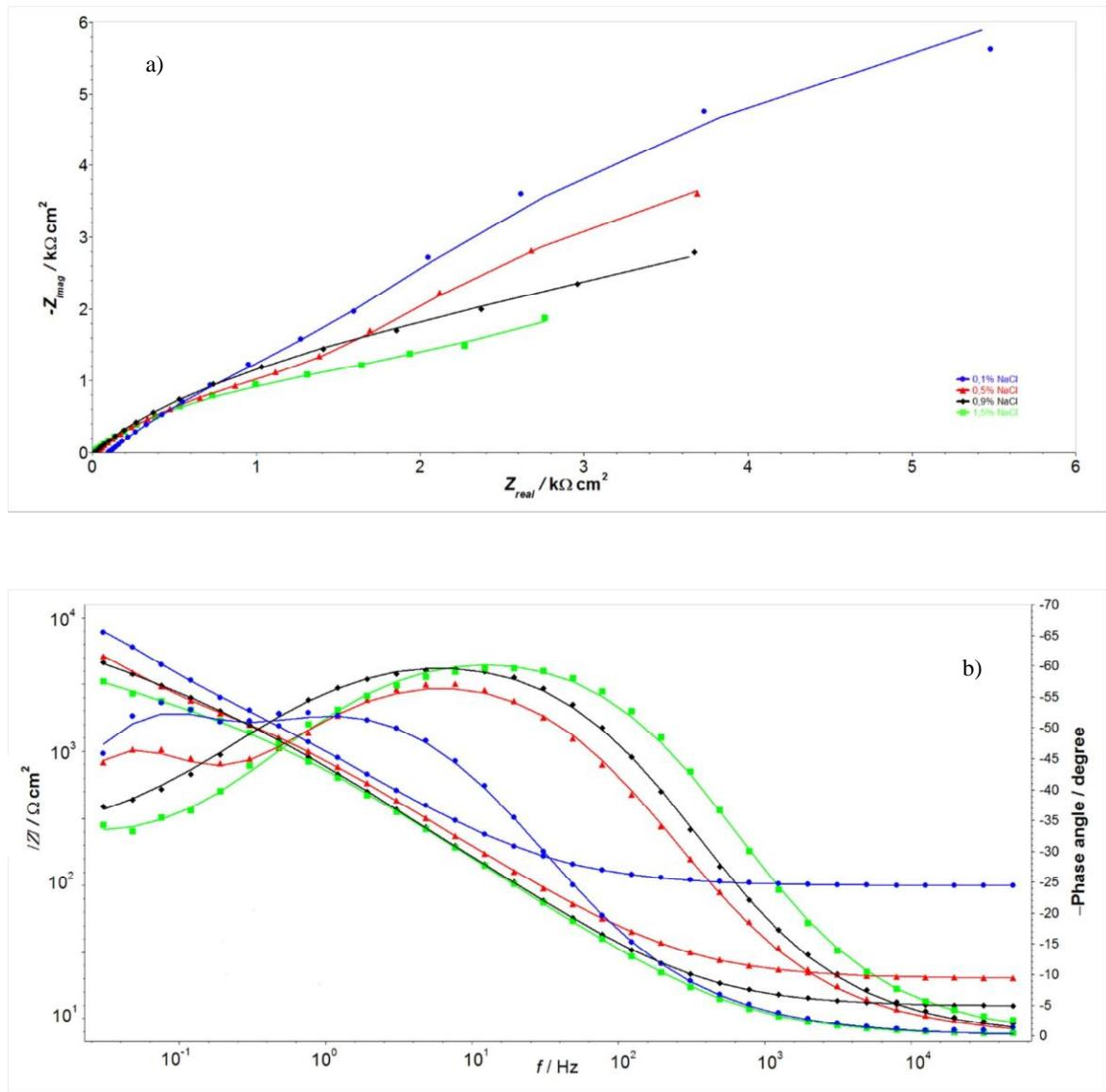
**Slika 25.** Nyquistov a) i Bodeov b) prikaz impedacijskog spektra za CuAlNi elektrodu u 0.1 % (-), 0.5 % (-), 0.9 % (-) i 1.5 % (-) NaCl otopini
