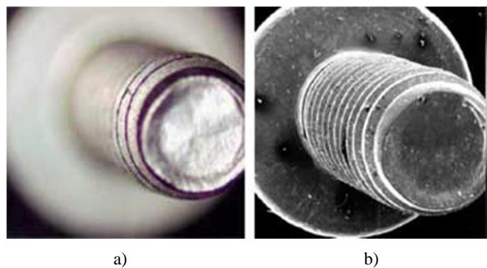
**Slika 18.** Usporedni prikaz slike objekta dobiven pomoću optičkog mikroskopa a) i pretražnog elektronskog mikroskopa (SEM) b)<sup>56</sup>
