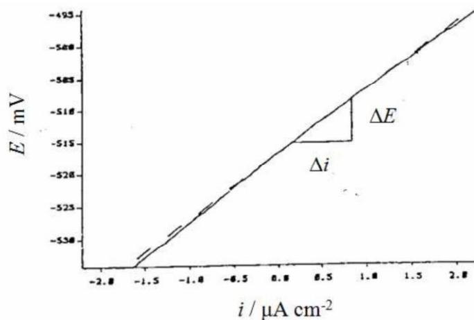
**Slika 16.** Određivanje polarizacijskog otpora iz nagiba polarizacijske krivulje u blizini koroziskog
