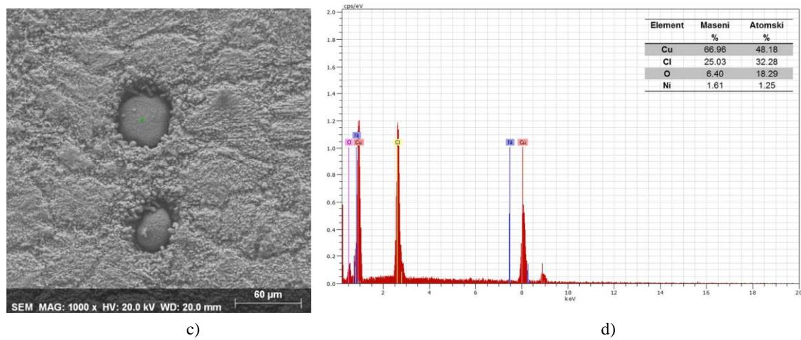
**Slika 32.** SEM snimka površine uzorka CuAlNi legure nakon potenciodinamičkog polarizacijskog mjerjenja u 0.9 % NaCl otopolini (uvećanje 1000 puta) i pripadajuća EDS analiza
