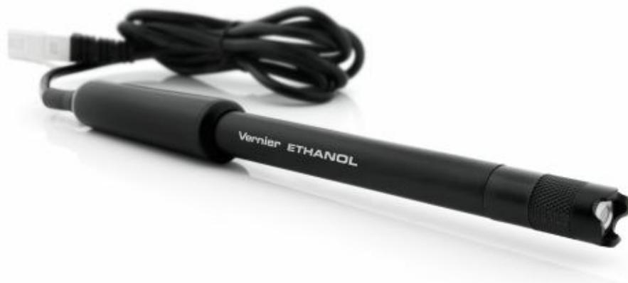
**Slika 6.** Vernierovo mjerno osjetilo za određivanje etanola (1).
