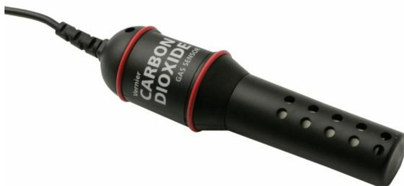
**Slika 5.** Vernierovo osjetilo za mjerenje plinovitog CO<sub>2</sub> (1).
