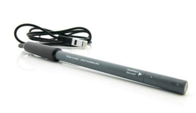
**d)** kalijeva ion-selektivna elektroda
