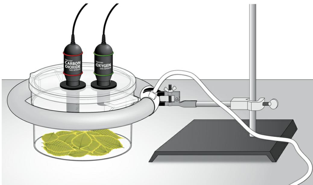
**Slika 30.** Apratura za proces fotosinteze (1).
