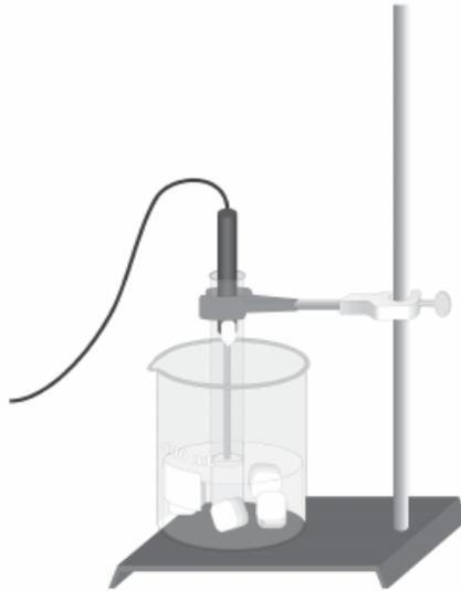
**Slika 24.** Aparatura za određivanje temperature smrzavanja vode (*I*)
