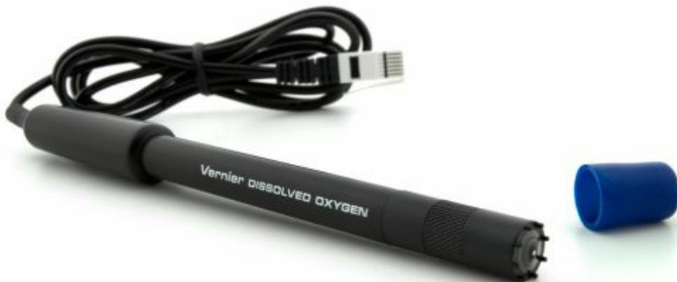
**Slika 7.** Vernierovo mjerno osjetilo za određivanje otopljenog kisika (*1*).
