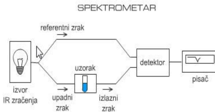
**Slika 13.** Princip rada spektrometra (8).
