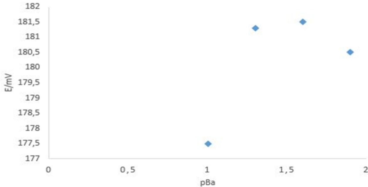
*Prikaz testiranja odziva elektrode na barijeve katione*
