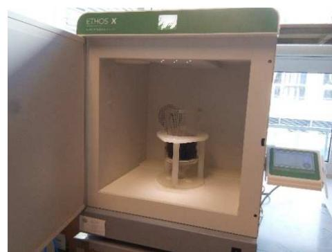
*Slika 9. Postavljanje uzorka u mikrovalnu peć*
