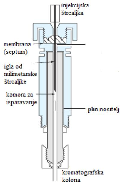
*Slika 8 Injektor za ubacivanje uzorka u plinski kromatograf (20)*
