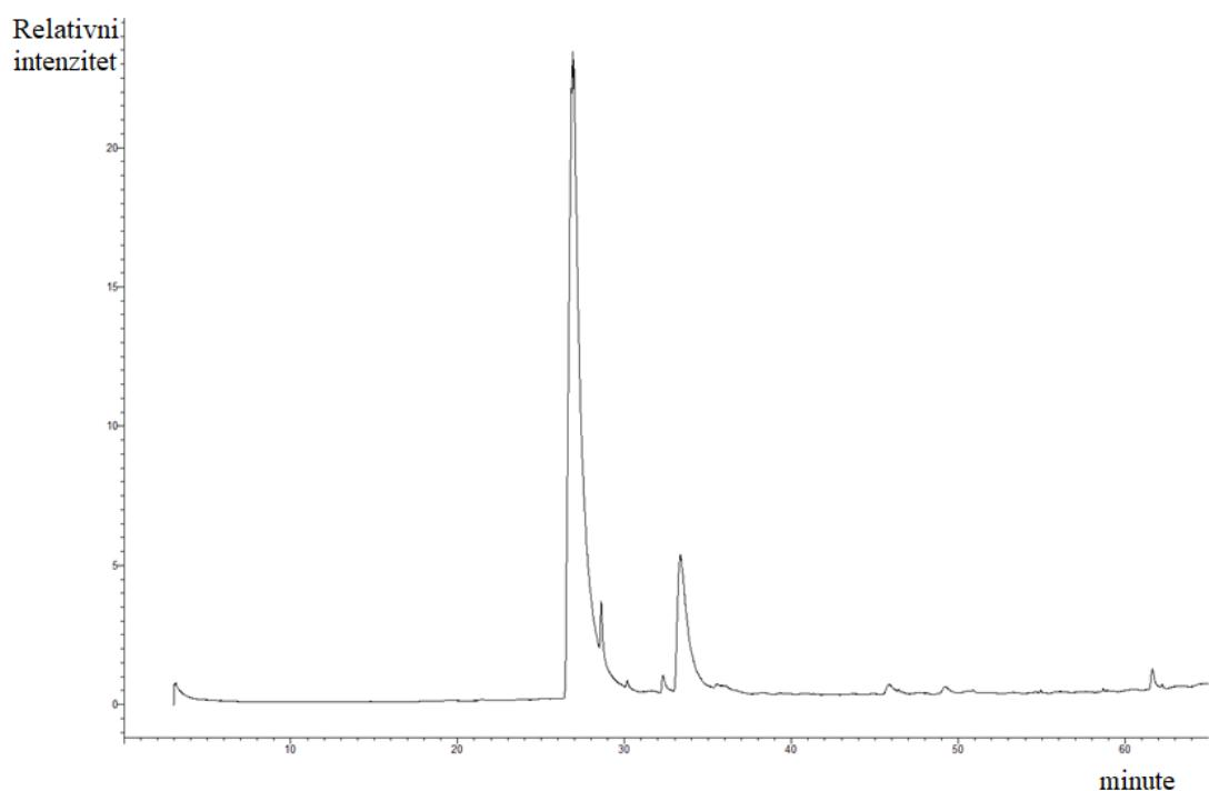
*Slika 18. Kromatogram GC-MS analize eteričnog ulja klinčića*
