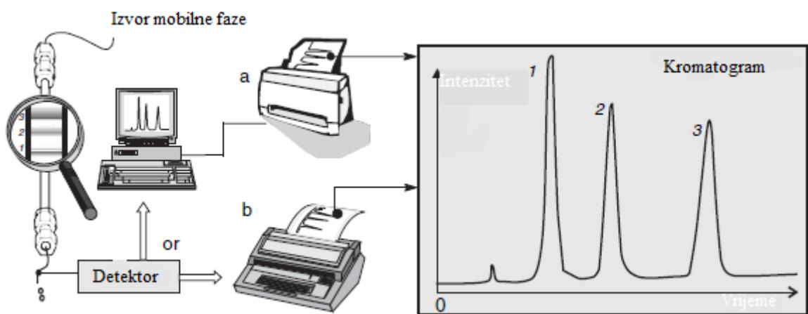
Slika 10. Shema kromatografskog sustava i prikaz dobivenog kromatograma (23)
