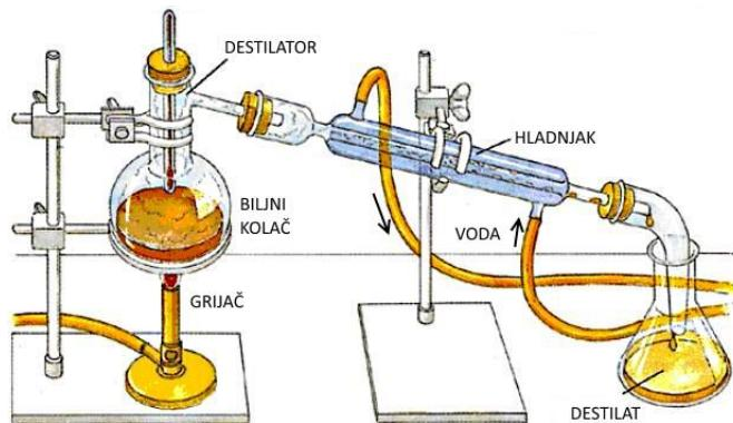
*Slika 4. Laboratorijska aparatura za vodenu destilaciju (14)*
