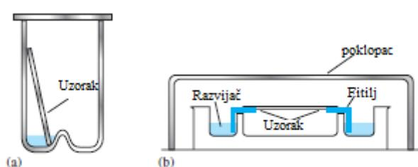
Slika 6 Načini razvijanja tankoslojne kromatografije: a) komora za uzlazno razvijanje kromatograma, b) komora za vodoravno razvijanje kromatograma (20)
