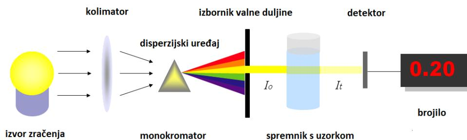
Slika 13. Shematski prikaz spektrofotometra<sup>22</sup>
