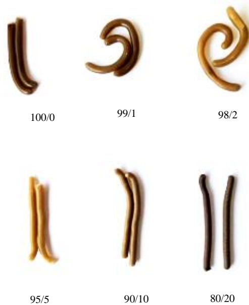
Slika 18. Uzorci mješavina PVC/ES dobiveni ekstrudiranjem pri 170 °C.
