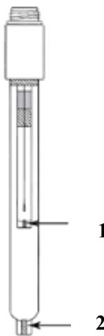
**Slika 2.** Dvojspojna referentna elektroda s prikazanim unutarnjim (1) i vanjskim spojem (2).<sup>5</sup>
