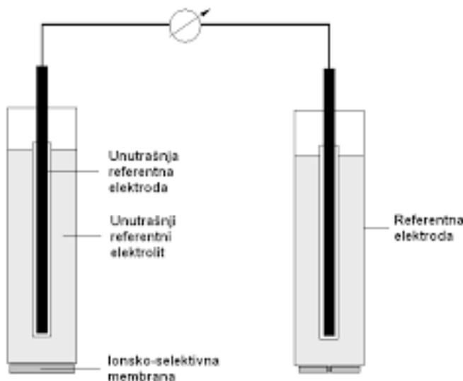
Slika 8. Prikaz elektrode s kristalnom membranom.<sup>10</sup>
