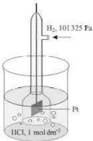
**Slika 3.** Standardna vodikova elektroda.<sup>6</sup>
