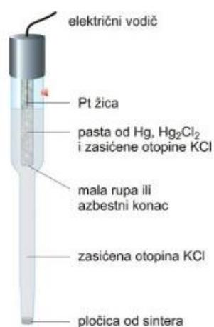
**Slika 4.** Kalomelova elektroda.<sup>7</sup>
