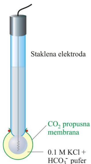
**Slika 10.** Prikaz elektrode za plinove.<sup>7</sup>
