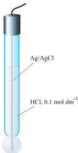
Slika 9. Staklena pH elektroda.<sup>7]</sup>
