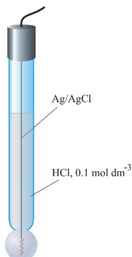
**Slika 5.** Referentna elektroda srebro/srebrov klorid.<sup>7</sup>
