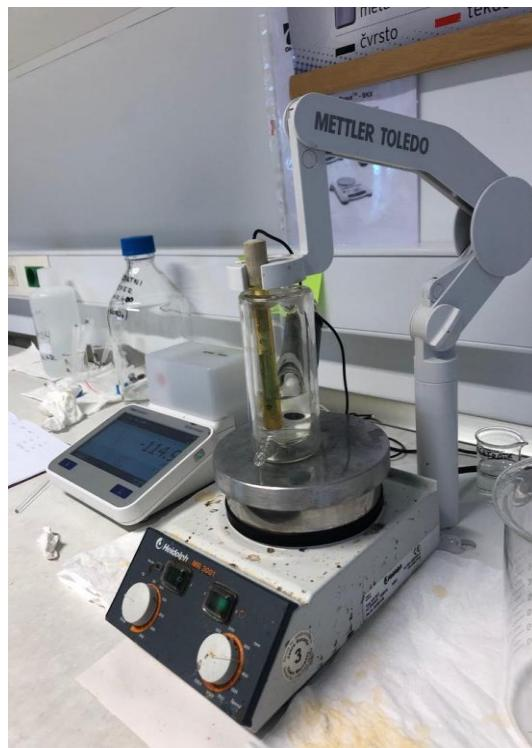
Slika 12. Aparatura za potenciometrijsko mjerjenje.
