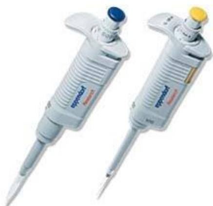
Slika 3.14. Mikropipete s ručnim držačem.
