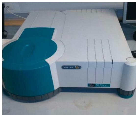
Slika 7. UV-VIS spektrofotometar
