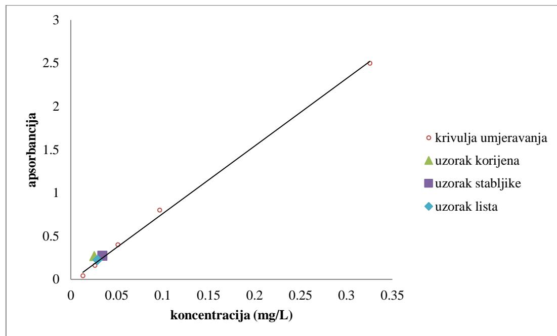
Slika 8. Krivulja umjeravanja za određivanje količine lakopristupačnog fosfora
