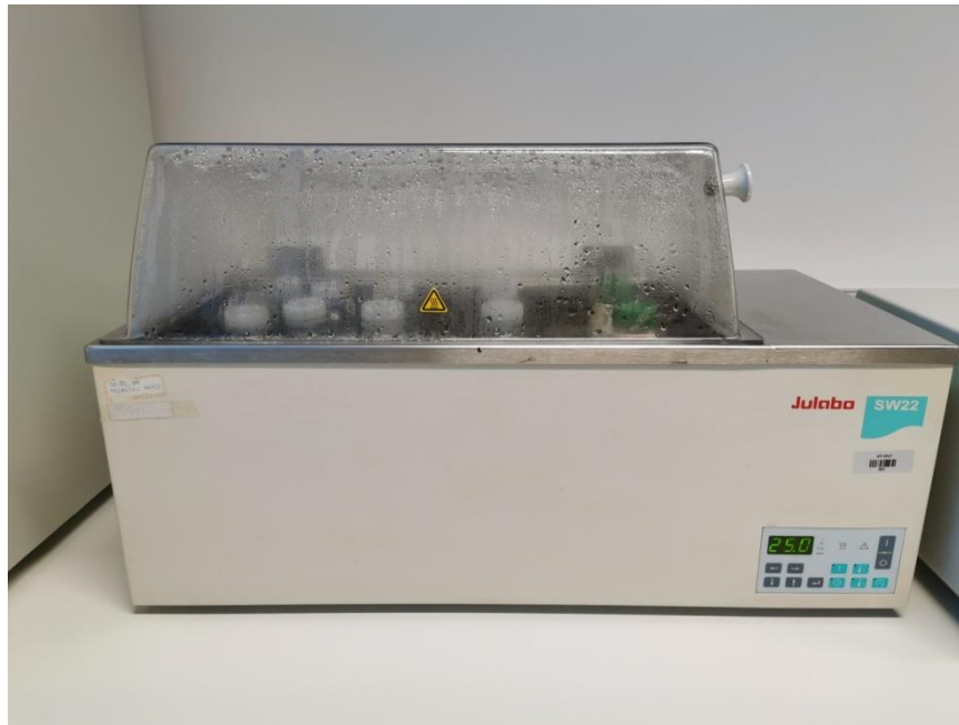
Slika 2.7. Reaktori u vodenoj kupelji s trešnjom
