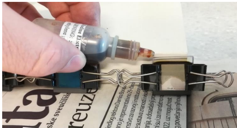
Slika 28. Dodatak otopine elektrolita
