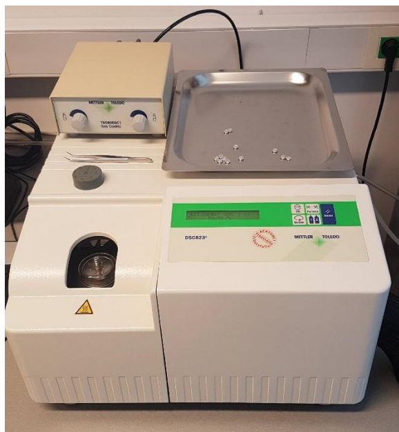
Slika 25. Diferencijalni pretražni kalorimetar DSC 823 e (Mettler Toledo)
