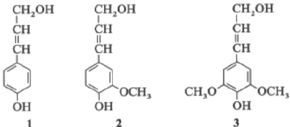
**Slika 8.** Dominanti gradični elementi trodimenzionalnog polimera lignina<sup>23</sup>
