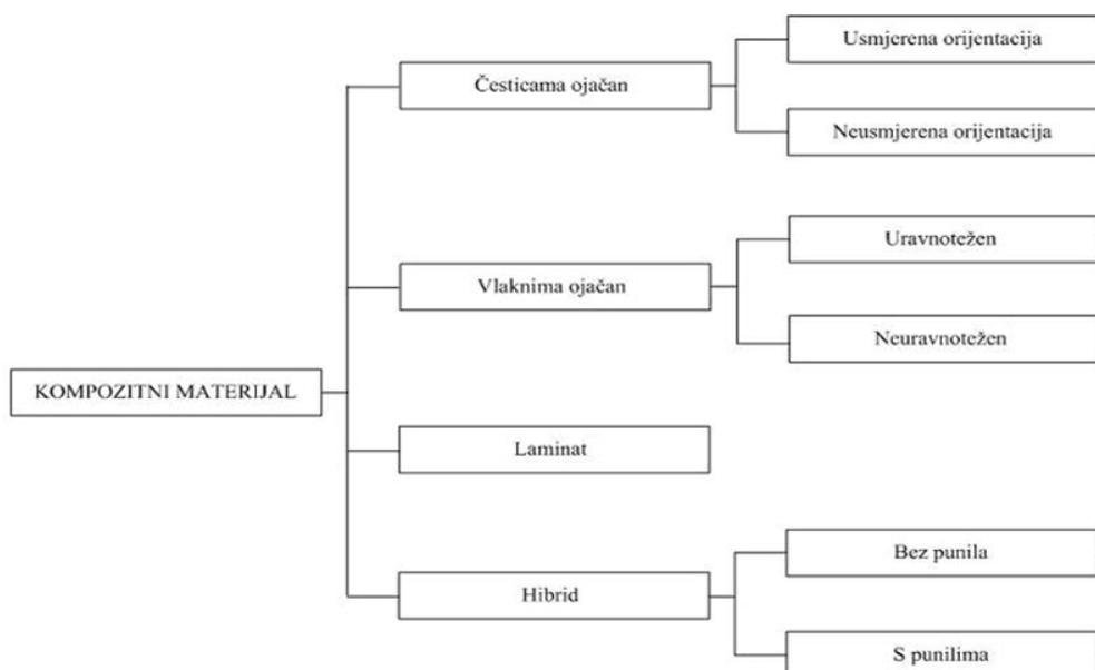
**Slika 4.** Podjela polimernih kompozita prema vrsti ojačala<sup>11</sup>
