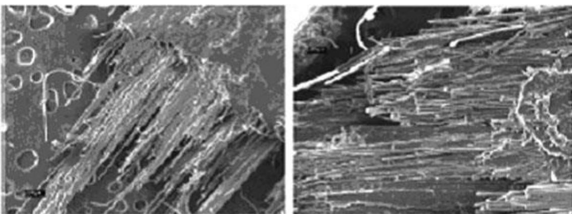
**Slika 9.** Mikroskopske fotografije prijeloma površine neobrađenih i obrađenih kompozita<sup>27</sup>
