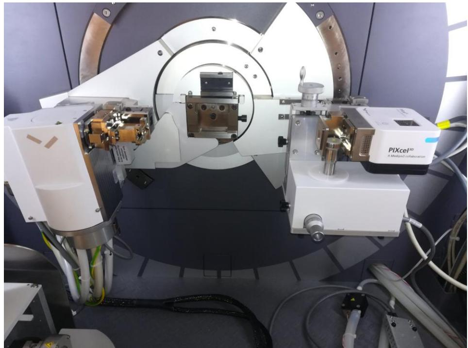
Slika 107. Uređaj Malvern Panalytical Empyrean s modulom za CT mjerena
