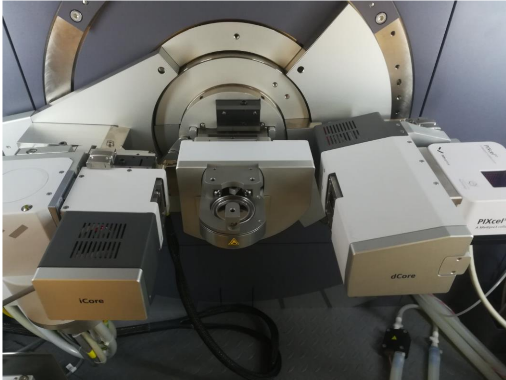
Slika 19. Difraktometar Malvern Panalytical Empyrean
