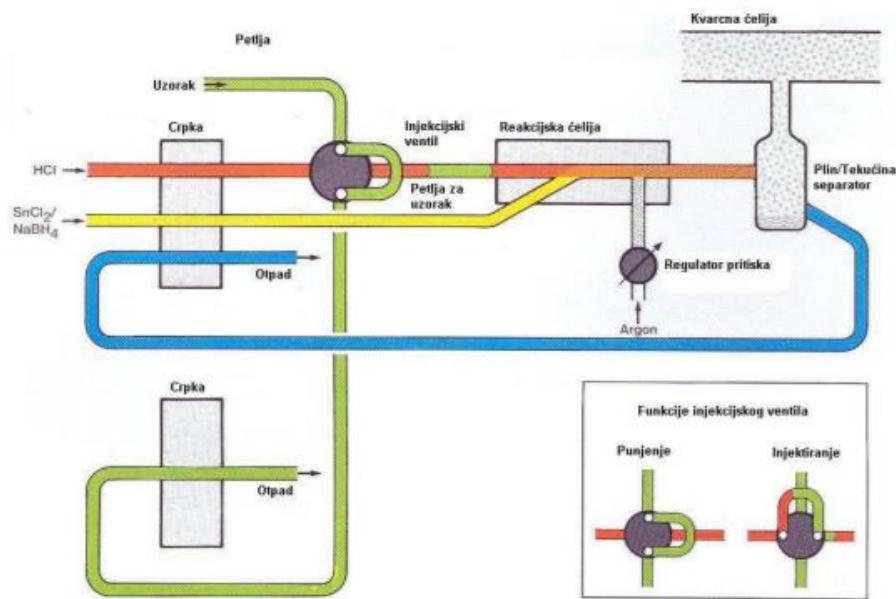
**Slika 10.** Princip rada hidridne tehnike.<sup>12</sup>
