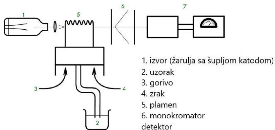
Slika 5. Shematski prikaz atomizacije plamenom.<sup>12</sup>
