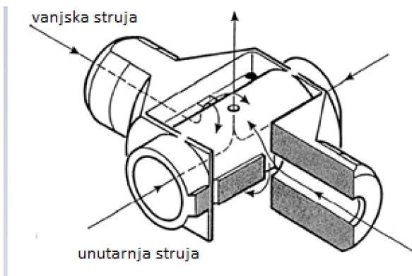
**b)** Protok struje inertnog plina.<sup>12</sup>
