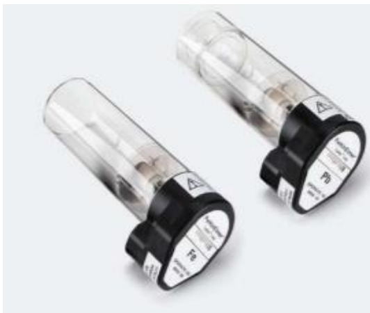
Slika 11. Žarulja sa šupljom katodom. 12
