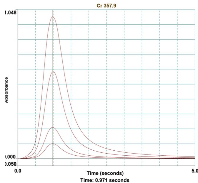
**Slika 22.** Instrumentni zapis analize standardnih otopina.
