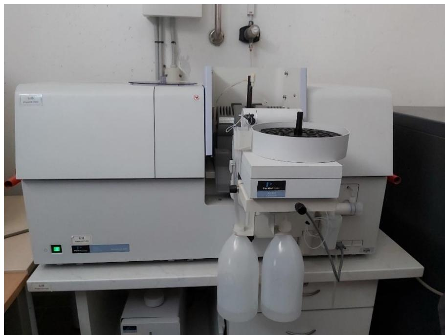
**Slika 20.** Atomski apsorpcijski spektrometar
