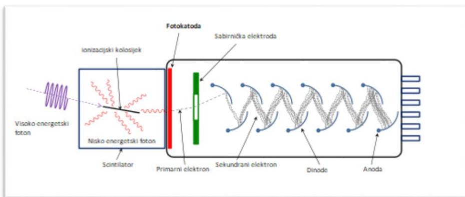
Slika 14. Shematski prikaz fotomultiplikatora.<sup>15</sup>
