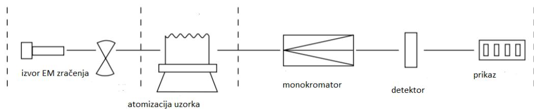
**Slika 3.** Shema atomskog apsorpcijskog spektrometra.<sup>14</sup>
