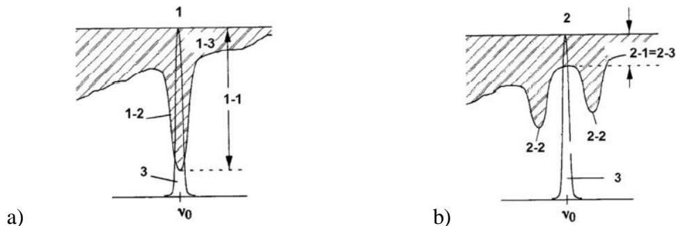
**Slika 15.** Zeemanov efekt **a)** isključeno magnetsko polje; **b)** uključeno magnetsko polje<sup>12</sup>
