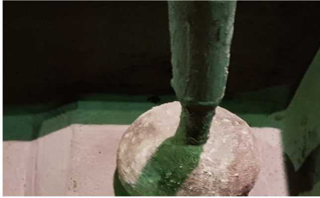
Slika 46. Kugla blokira ulaz taline u kalup [24]
