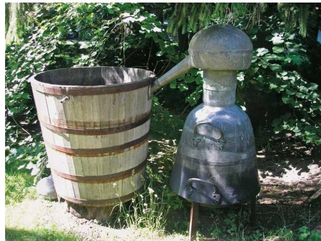
**Slika 3. Alambik-klasični uređaj za dobivanje eteričnog ulja ruže hidrodestilacijom<sup>1</sup>**
