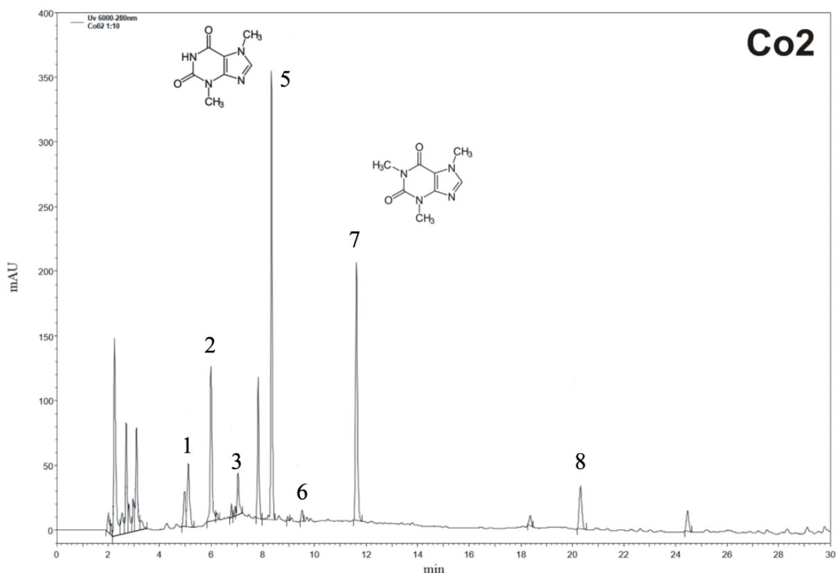
**Slika 12.** Reprezentativni HPLC-DAD kromatogram uzorka meda *Coffea* spp. (Co2) snimljen pri 280 nm; broj pika odgovara broju spoja u tablici 39.
