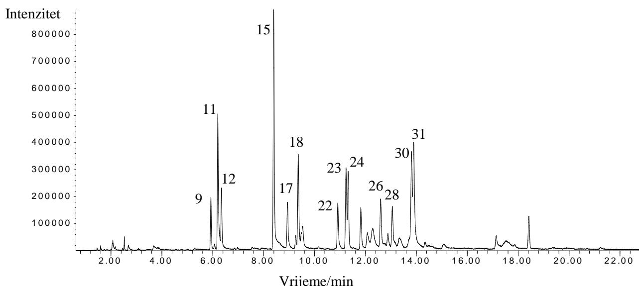
**Slika 9.** Reprezentativni kromatogram ukupne ionske struje isparljivih spojeva meda *Coriandrum sativum* L. izoliranih HS-SPME metodom koristeći vlakno DVB/CAR/PDMS; broj pika odgovara broju spoja u tablici 20.
