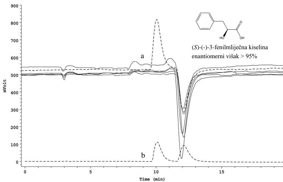
**Slika 14.** Kromatogrami kiralne analize ekstrakata meda (pune linije) primjenom polarimetrijskog detektora (a). Kromatogrami kiralne analize standarda  $(\pm)$ -3-fenilmlijecne kiseline (ispredidane linije) primjenom OR (a) i UV (b) detektora.
