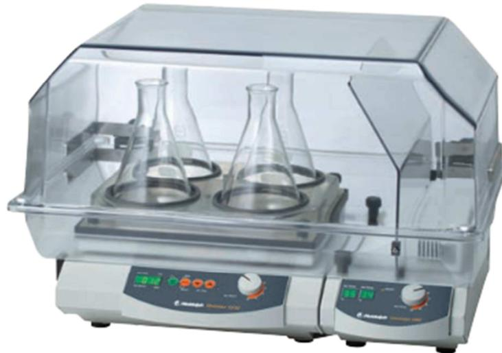
Slika 2.2. Inkubatorska tresilica „Heidolph Unimax 1010“.
