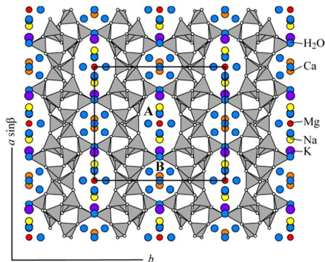
Slika 1.13. Prostorna struktura klinoptilolita sa smještajem izmjenjivih kationa.<sup>20</sup>
