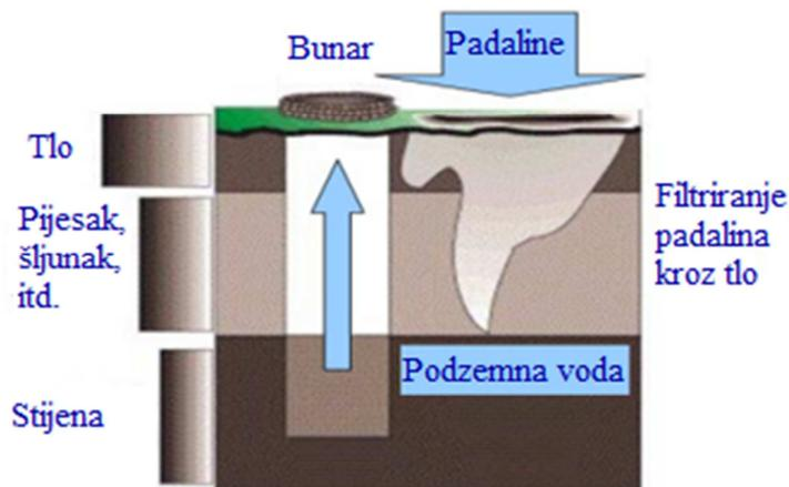
Slika 1.7. Shematski prikaz filtriranja oborinskih voda u sloju tla.<sup>22</sup>
