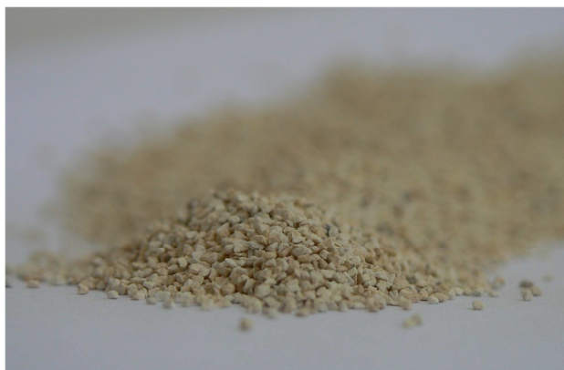
Slika 2.1. Uzorak prirodnog zeolita klinoptilolita veličine čestica 0,6 - 0,8 mm.*
