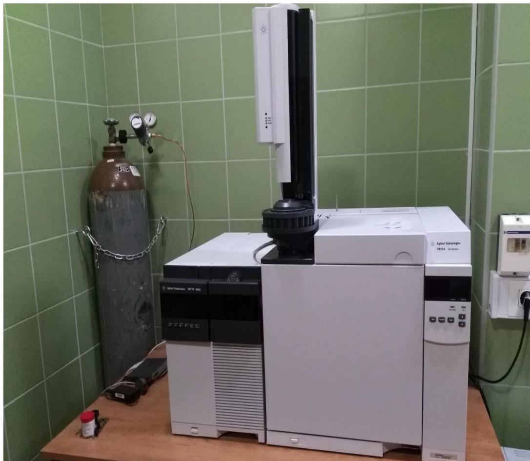
Slika 10. Vezani sustav plinska kromatografija-spektrometrija masa (GC-MS)
