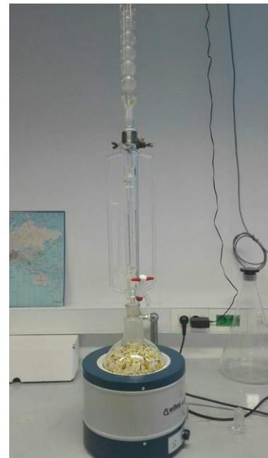
*Slika 18.* Aparatura za hidrodestilaciju aparat po Clevengeru
