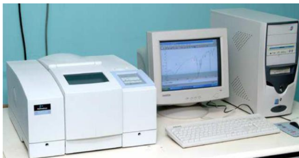
Slika 24. FT-IR spektrometar, Perkin-Elmer Spectrum One
