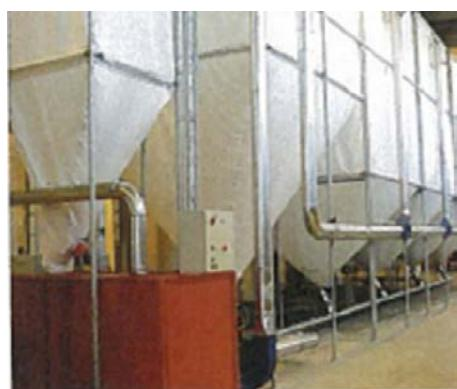
Slika 11. Silosi za stabilizaciju granula stiropora<sup>14</sup>
