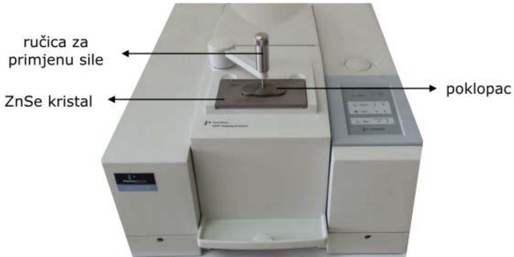
Slika 35. FT-IR spektrometar Spectrum One (Perkin–Elmer) s dodatkom za snimanje HATR tehnikom<sup>4</sup>
