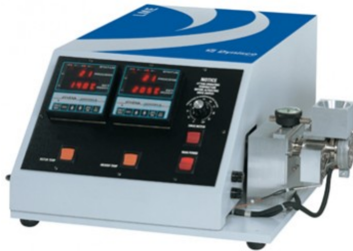
Slika 22. Jednopusni laboratorijski ekstruder Dynisco
