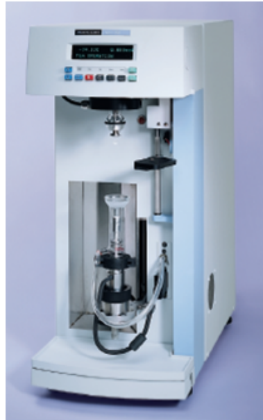
Slika 24. Aparatura za termogravimetrijsku analizu Pyris 1 TGA
