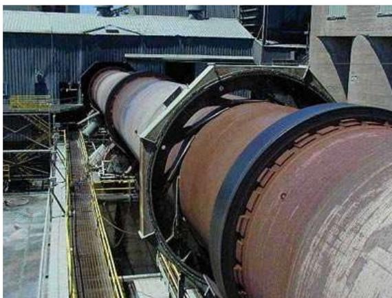
Slika 4. Klizni ležajevi rotacijske peći<sup>5</sup>
