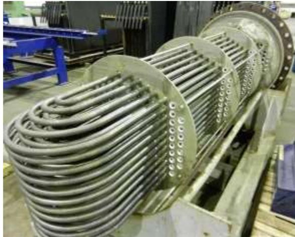
Slika 5. Izmjenjivač topline sa cijevnim snopom<sup>10</sup>
