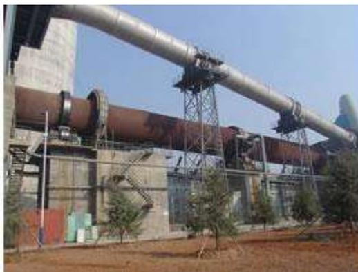
Slika 2. Rotacijska peć u postrojenju za dobivanje cementa<sup>3</sup>
