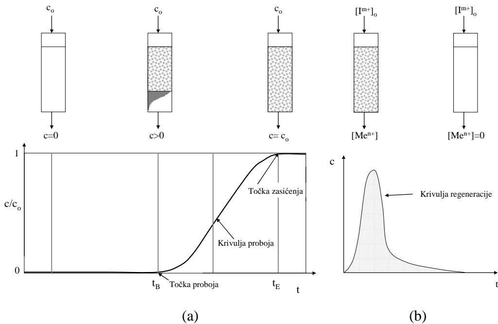
Slika 1.14. a) Shematski prikaz provedbe postupka u koloni i opis tipične krivulje probroja.
