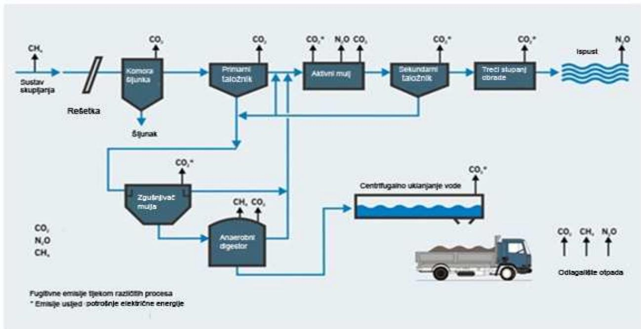
Slika 1.3. Tipična shema uređaja za obradu otpadnih voda i emisija CO<sub>2</sub><sup>10</sup>
