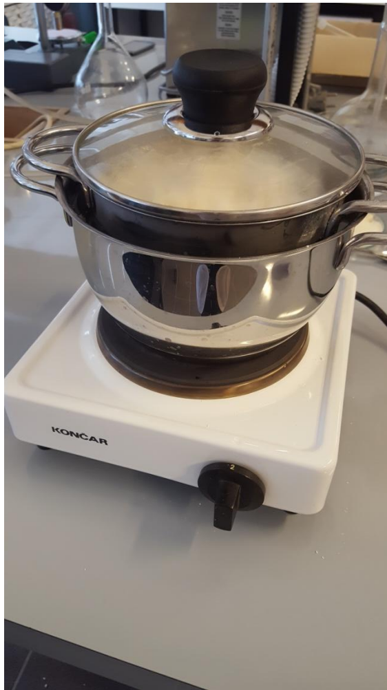
Slika 7. Zagrijavanje sapuna na vodenoj kupelji
