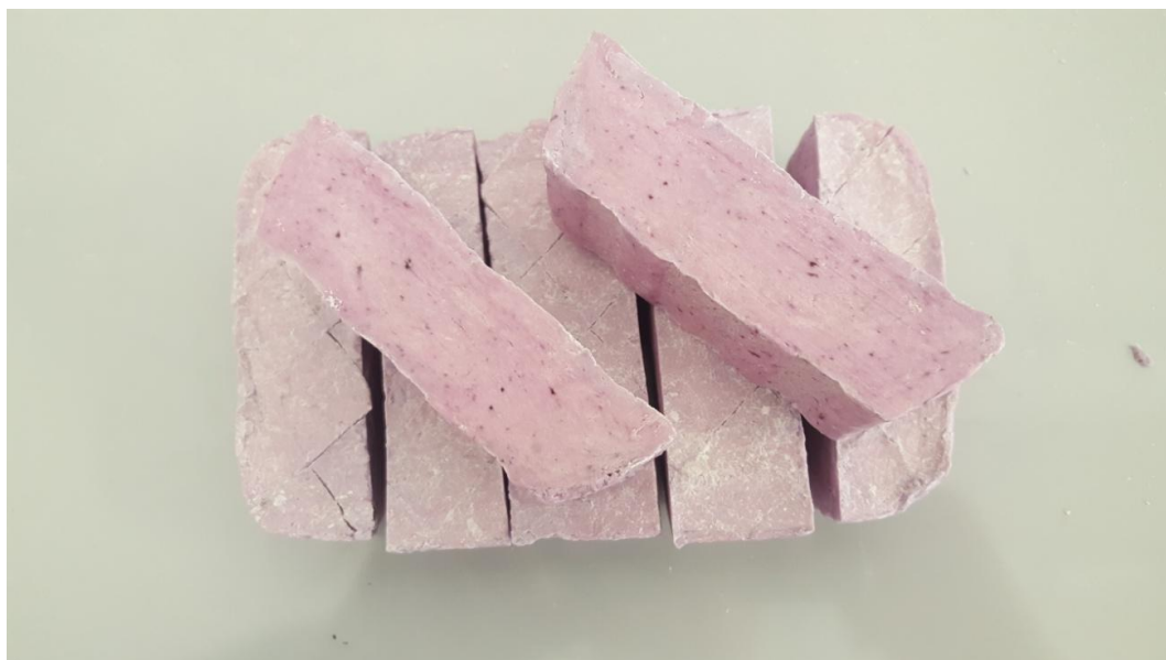
Slika 11. Sapun s nedovoljno otopljenim bojilom
