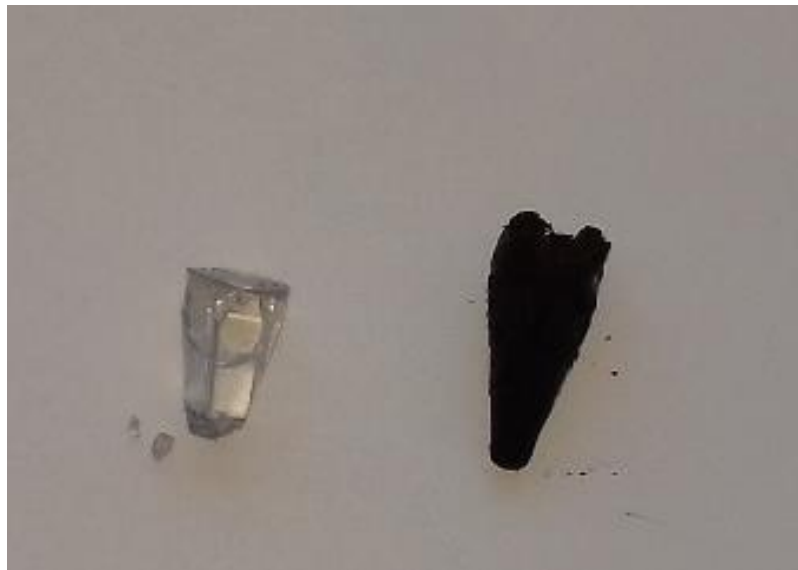
Slika 16 Formirani gel prema metodi 4 (lijevo). Pripravljene kompozit ugljikovih nanocijevi i osjetilnog materijala u silikatnom materijalu (desno).
