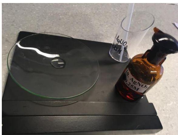
Slika 3.7. Negativna reakcija na kloride
