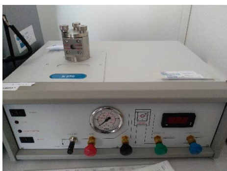
Slika 14. Sušilica na principu kritične točke
