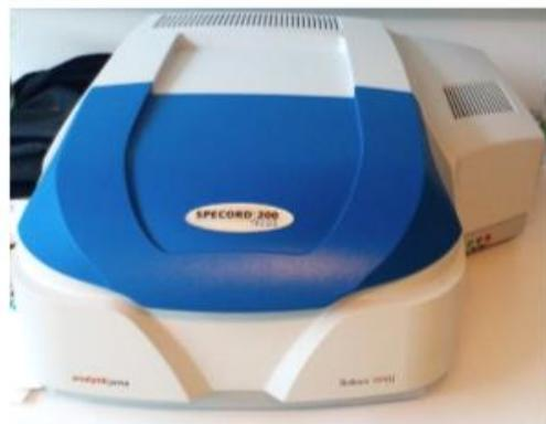
**Slika 14.** UV-Vis spektrofotometar
