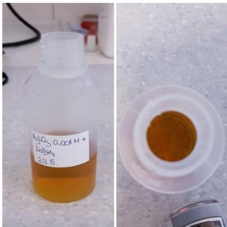
**Slika 7.** Tyndallov efekt uzorak koloidnog srebra dobivenog pomoći natrijevog borohidrida
