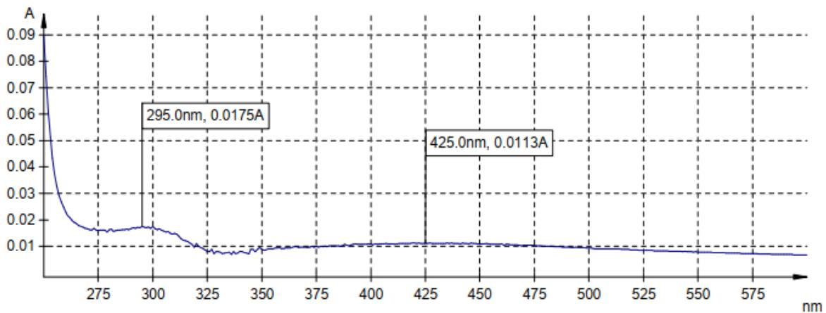
**Slika 19.** Apsorpcijski spektar koloidnog srebra dobivenog pomoću  $0.016\text{ M}$  trinatrijevog citrata dihidrata pri  $95\text{ }^{\circ}\text{C}$
