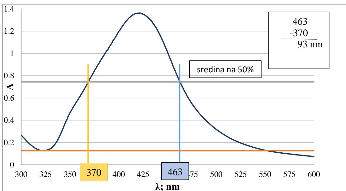
**Slika 24. .** Prikaz očitanja PWHM, nm, za uzorak dobiven pomoću 0,040 M askorbinske kiseline, pri 50 °C
