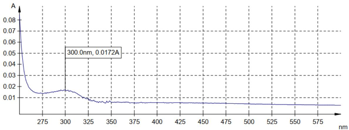
**Slika 18.** Apsorpcijski spektar koloidnog srebra dobivenog pomoću  $0.010\text{ M}$  trinatrijevog citrata dihidrata pri  $95\text{ }^{\circ}\text{C}$
