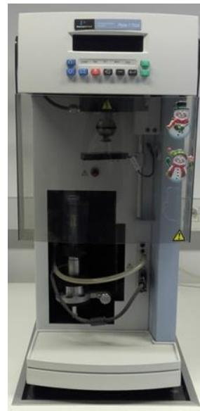
Slika 11. Pyris 1 TGA (Perkin-Elmer) termogravimetar
