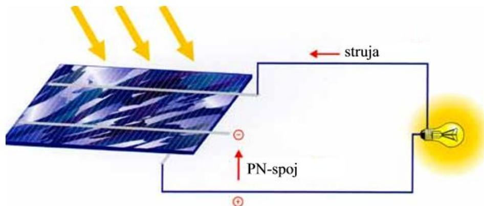
Slika 3. Tok nastale struje kod solarne ćelije <sup>5</sup>
