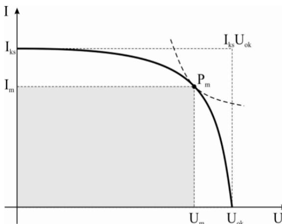
**Slika 5.** Osnovni parametri solarne ćelije <sup>7</sup>
