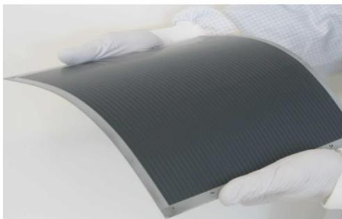
**Slika 10.** CIGS solarna ćelija <sup>17</sup>
