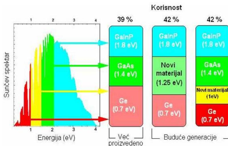
**Slika 13.** Slaganje poluvodičkih materijala višeslojnih ćelija od većeg prema manjem energijskom procjepu uz iskorištavanje različitih dijelova sunčevog zračenja<sup>25</sup>
