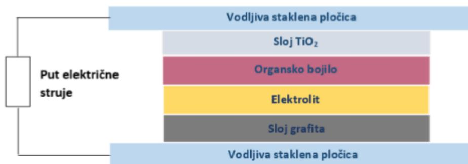
Slika 15. Struktura Grätzelove solarne ćelije <sup>25</sup>
