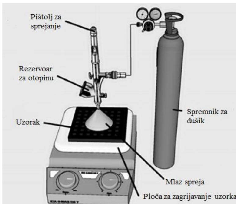
Slika 17. Oprema za sprej tehniku<sup>38</sup>
