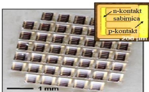
**Slika 14.** Višeslojna InGaP/GaAs/InGaAs solarna ćelija<sup>26</sup>
