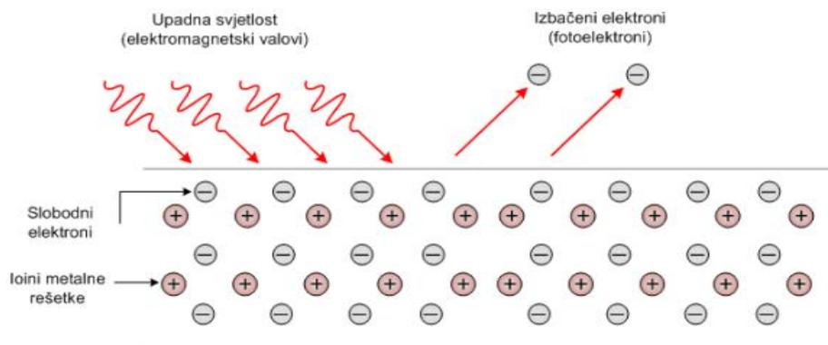
**Slika 2.** Fotoelektrični efekt <sup>4</sup>
