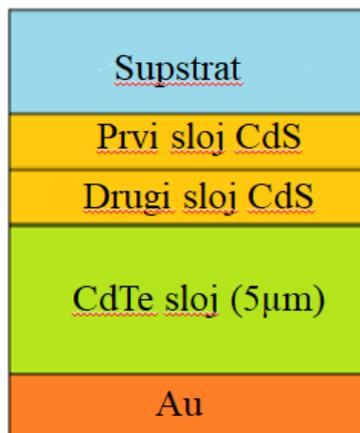
**Slika 9.** Dvoslojna CdTe solarna ćelija <sup>15</sup>
