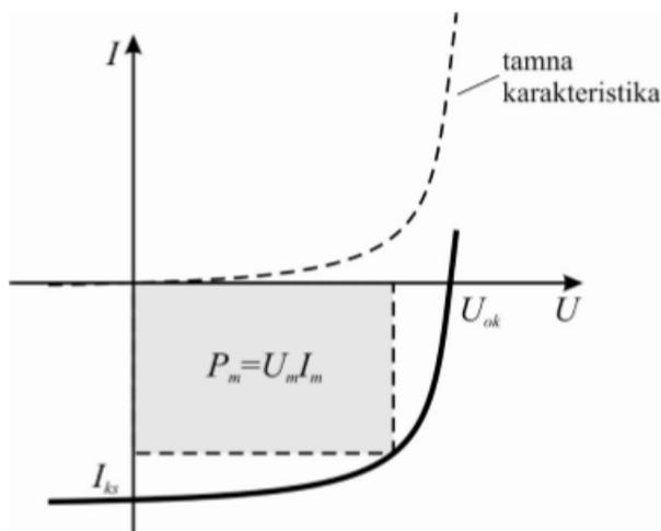
**Slika 4.**  $I$ - $U$  karakteristika neosvjetljene i osvjetljene solarne ćelije <sup>6</sup>
