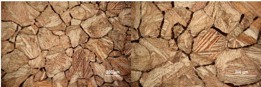
Slika 25. Površina CuAlNi legure nakon potenciodinamičkog polarizacijskog ispitivanja u 0,5 \text{ mol dm}^{-3} \text{ H}_2\text{SO}_4 otopini pri 40 \text{ }^\circ\text{C} i 150 \text{ o/min} .
