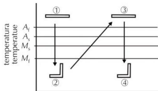
**Slika 8.** Shematski prikaz dvosmjernog efekta prisjetljivosti oblika<sup>(19)</sup>
