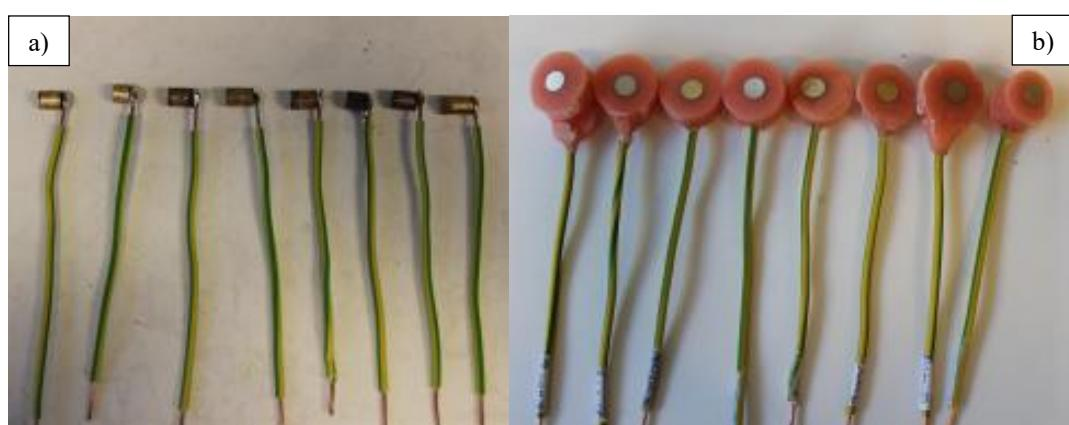
Slika 13. Izrada elektroda za elektrokemijska mjerena
