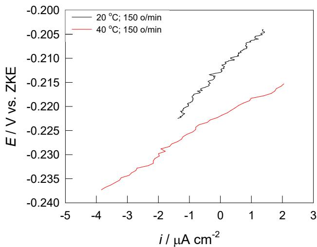
**Slika 19.** Linearni dijelovi polarizacijskih krivulja za CuAlNi leguru u  $0,5 \text{ mol dm}^{-3}$   $\text{H}_2\text{SO}_4$  otopini pri  $150 \text{ o/min}$  i različitim temperaturama elektrolita
