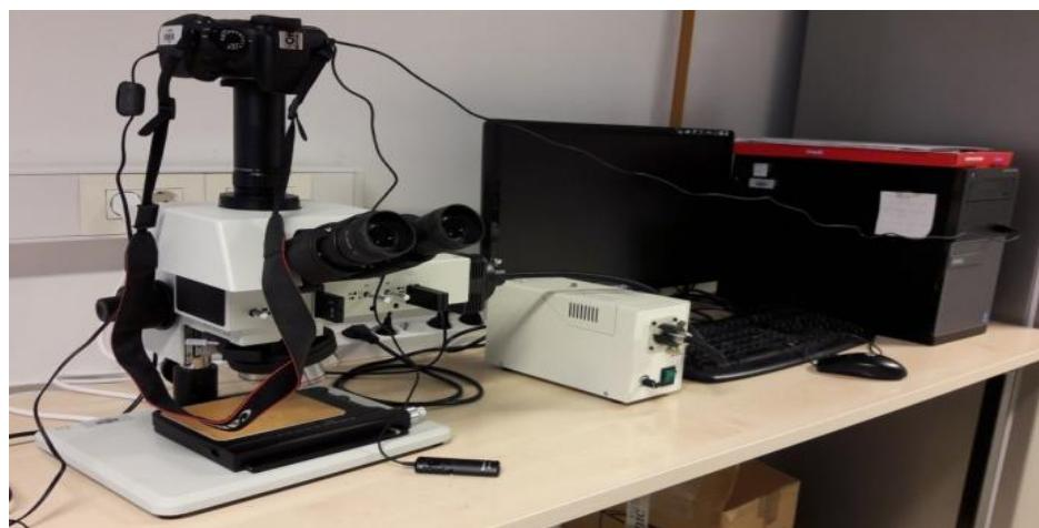
**Slika 16.** Svjetlosni mikroskop MXFMS-BD, Ningbo Sunny Instruments co. povezan s računalom
