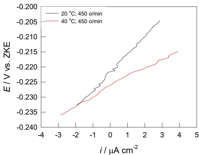
**Slika 20.** Linearni dijelovi polarizacijskih krivulja za CuAlNi leguru u  $0,5 \text{ mol dm}^{-3}$   $\text{H}_2\text{SO}_4$  otopini pri  $450 \text{ o/min}$  i različitim temperaturama elektrolita
