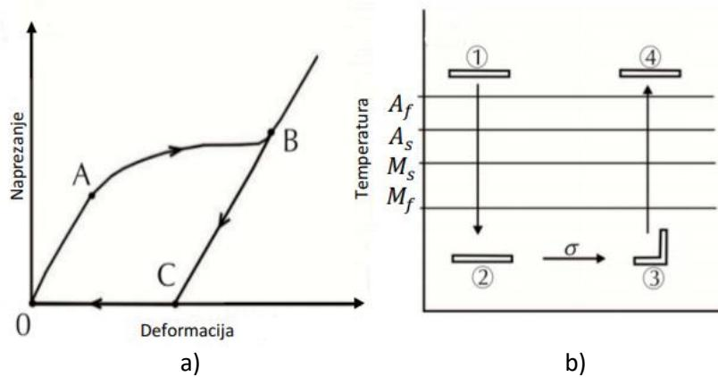
**Slika 7.** Prikaz dijagrama naprezanje-deformacija za leguru s prisjetljivosti oblika (a) i shematski prikaz dijagrama jednosmjernog efekta prisjetljivosti oblika (b)<sup>(19)</sup>
