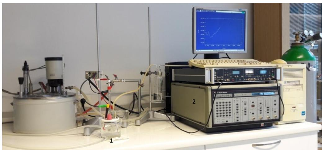
Slika 15. Aparatura za provedbu elektrokemijskih mjerena
