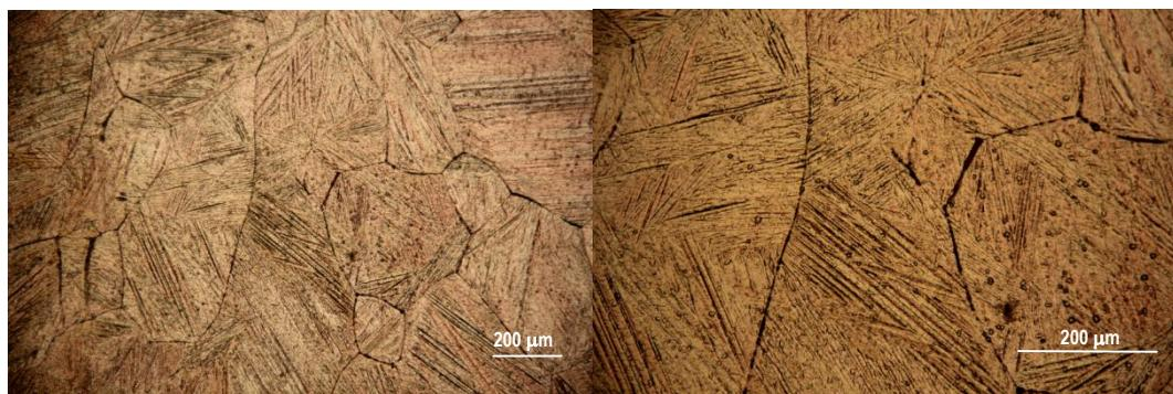
**Slika 23.** Površina CuAlNi legure nakon potenciodinamičkog polarizacijskog ispitivanja u  $0,5 \text{ mol dm}^{-3} \text{ H}_2\text{SO}_4$  otopini pri  $20^\circ\text{C}$  i  $150 \text{ o/min.}$
