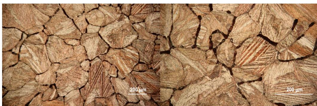
**Slika 25.** Površina CuAlNi legure nakon potenciodinamičkog polarizacijskog ispitivanja u  $0,5 \text{ mol dm}^{-3} \text{ H}_2\text{SO}_4$  otopini pri  $40^\circ\text{C}$  i  $150 \text{ o/min.}$
