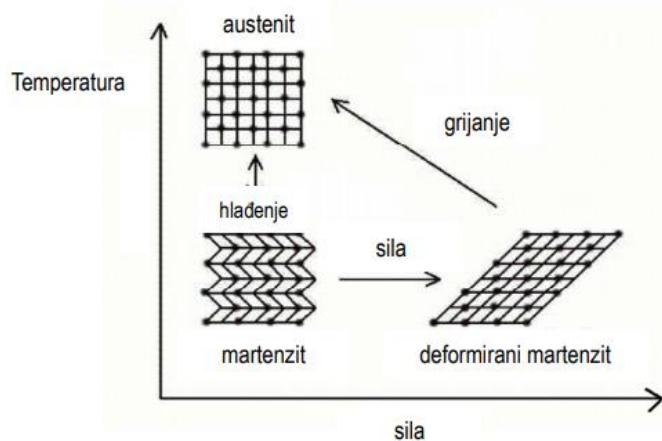
Slika 3. Ciklus promjena strukture za SMA legure<sup>(20)</sup>
