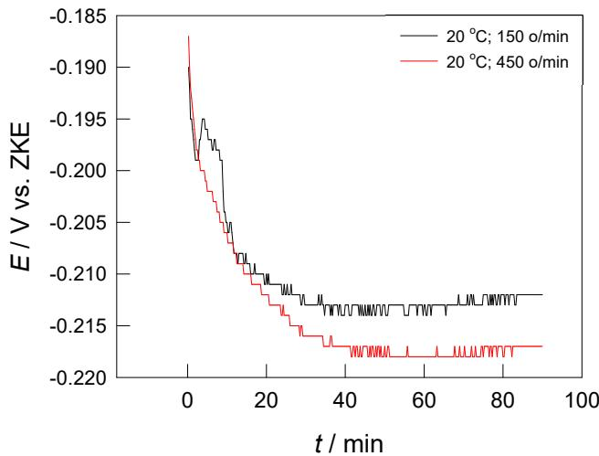
**Slika 17.** Vremenska ovisnost potencijala otvorenog strujnog kruga za CuAlNi leguru u  $0,5 \text{ mol dm}^{-3}$   $\text{H}_2\text{SO}_4$  otopini pri  $20^\circ\text{C}$  i različitim brzinama vrtnje magnetskog miješala
