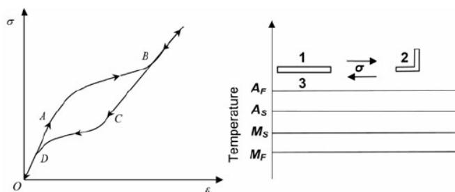
**Slika 6.** Dijagram naprezanje ( $\sigma$ )-deformacija ( $\varepsilon$ ) legura s prisjetljivosti oblika (lijevo) i shematski prikaz pseudoelastičnosti (desno)<sup>(19)</sup>
