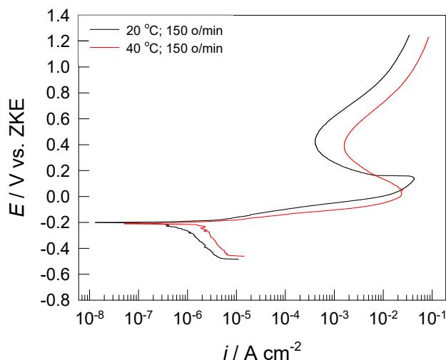
**Slika 21.** Potenciodinamičke polarizacijskih krivulja za CuAlNi leguru u  $0,5 \text{ mol dm}^{-3}$   $\text{H}_2\text{SO}_4$  otopini pri  $150 \text{ o}/\text{min}$  i različitim temperaturama elektrolita
