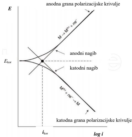
**Slika 12.** Određivanje korozijskih parametara iz polarizacijskih mjerjenja Tafelovom metodom<sup>(34)</sup>
