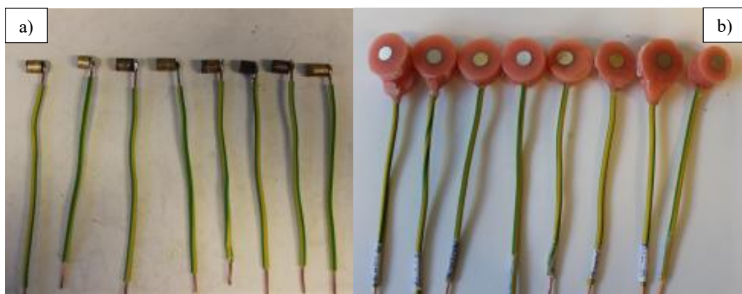
Slika 13. Izrada elektroda za elektrokemijska mjerenja
