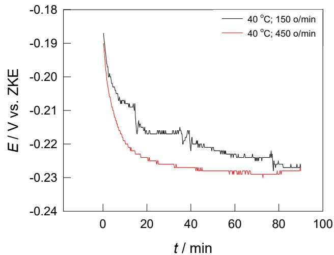
**Slika 18.** Vremenska ovisnost potencijala otvorenog strujnog kruga za CuAlNi leguru u  $0,5 \text{ mol dm}^{-3}$   $\text{H}_2\text{SO}_4$  otopini pri  $40^\circ\text{C}$  i različitim brzinama vrtnje magnetskog miješala
