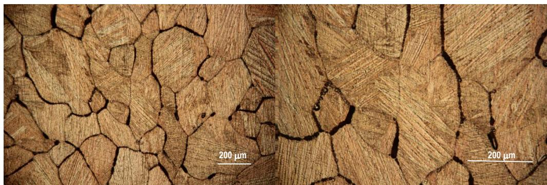
**Slika 26.** Površina CuAlNi legure nakon potenciodinamičkog polarizacijskog ispitivanja u  $0,5 \text{ mol dm}^{-3}$   $\text{H}_2\text{SO}_4$  otopini pri  $40^\circ\text{C}$  i  $450 \text{ o/min}$ .
