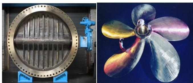
Slika 2. Primjena aluminijskih bronci: ventil (lijevo) i propeler (desno)<sup>(17)</sup>
