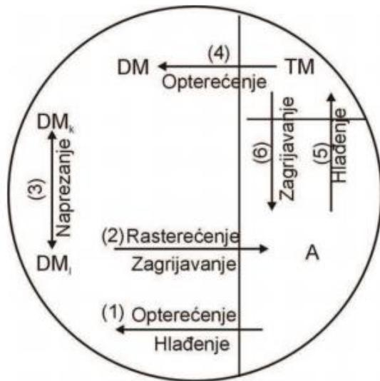
**Slika 5.** Shematski prikaz šest faznih transformacija legura s prisjetljivosti oblika; A - austenit, TM - samoprilagodjavajući martenzit, DM - naprezanjem inducirani martenzit,  $DM_k$  - naprezanjem inducirani martenzit (varijanta k) i  $DM_l$  - naprezanjem inducirani martenzit (varijanta l)<sup>(19)</sup>
