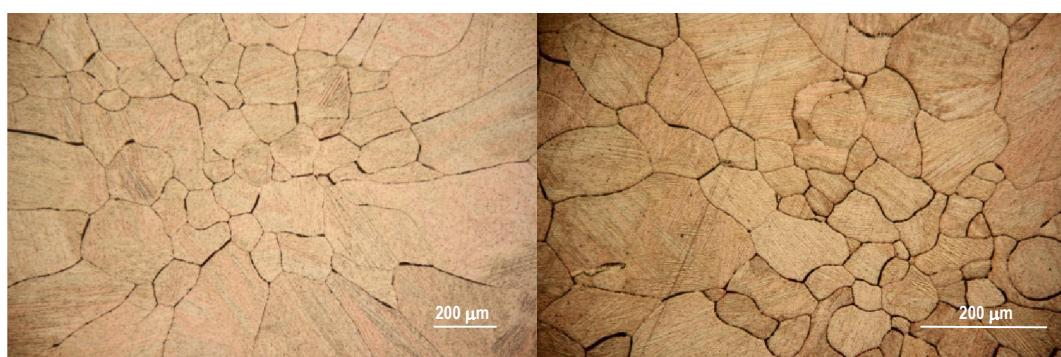
**Slika 24.** Površina CuAlNi legure nakon potenciodinamičkog polarizacijskog ispitivanja u  $0,5 \text{ mol dm}^{-3} \text{ H}_2\text{SO}_4$  otopini pri  $20^\circ\text{C}$  i  $450 \text{ o/min.}$
