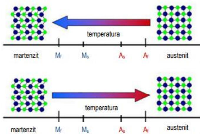
**Slika 4.** Temperaturno inducirane fazne transformacije SMA legura bez djelovanja mehaničke sile<sup>(20)</sup>
