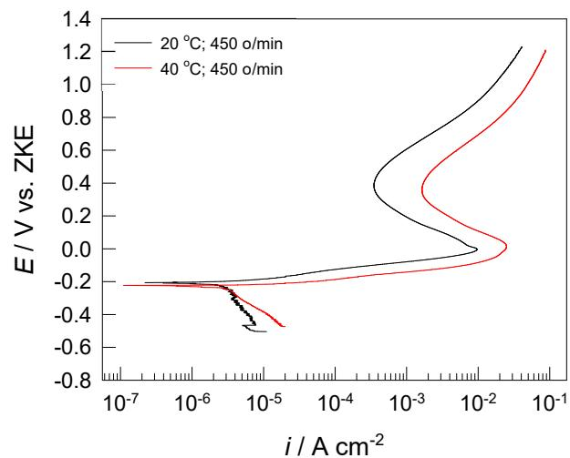
**Slika 22.** Potenciodinamičke polarizacijskih krivulja za CuAlNi leguru u  $0,5 \text{ mol dm}^{-3}$   $\text{H}_2\text{SO}_4$  otopini pri  $450 \text{ o}/\text{min}$  i različitim temperaturama elektrolita
