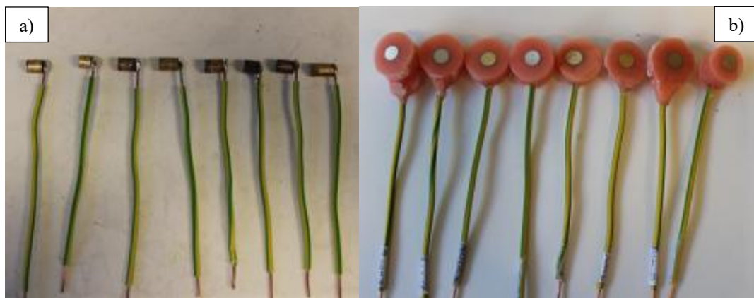
Slika 13. Izrada elektroda za elektrokemijska mjerenja
