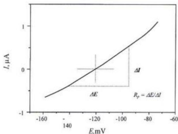
**Slika 11.** Određivanje polarizacijskog otpora metodom linearne polarizacije
