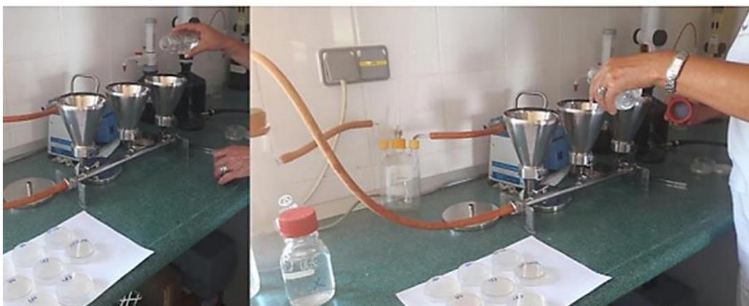
**Slika 20.** Provedba membranske filtracije pri određivanju koliformnih bakterija.
