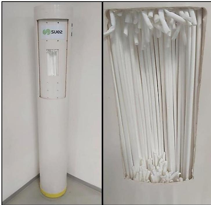
**Slika 31.** Membranski modul (SKID) sa 60 šupljih vlakana.
