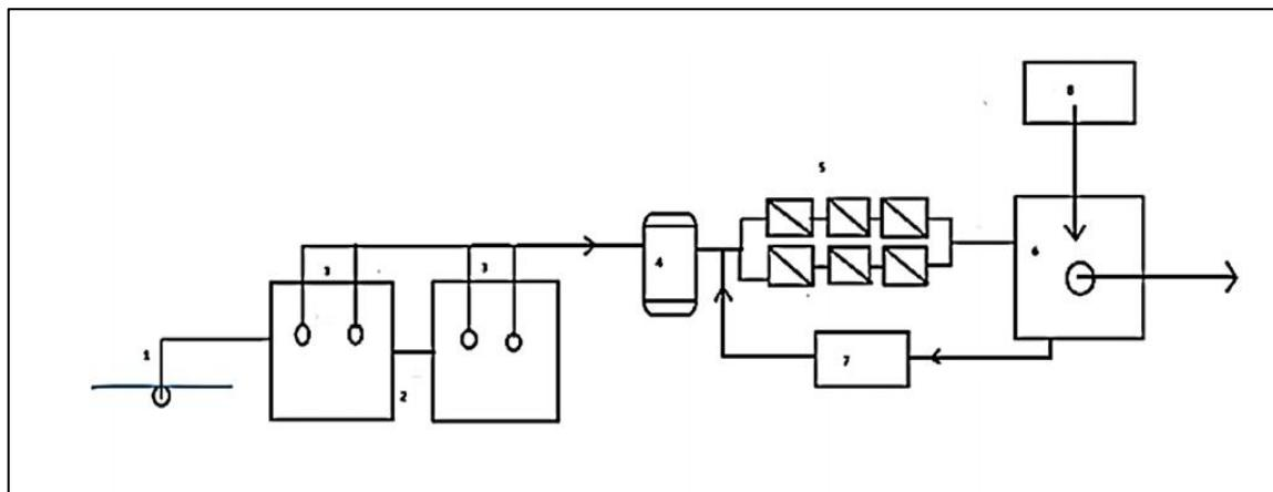
**Slika 26.** Pojednostavljena tehnološka shema uređaja za obradu pitke vode *UPPV Komolac* (1. crpno postrojenje; 2. spremnici sirove vode; 3. crpke za sustav filtracije; 4. mehanički filtri; 5. ultrafiltracija; 6. spremnik za pročišćenu vodu; 7. sustav za pranje UF jedinica; 8. klorna stanica).<sup>32</sup>
