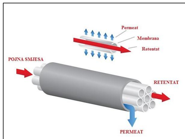
*Slika 15.* Cijevni modul.<sup>26</sup>
