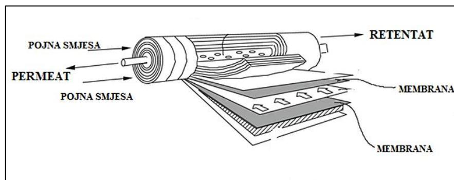
*Slika 14.* Modul sa spiralnim namotajem.<sup>25</sup>
