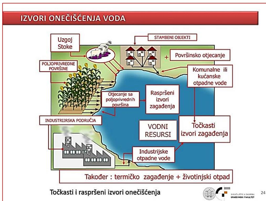
*Slika 3.* Točkasti i raspršeni ispusti onečišćenja.<sup>7</sup>
