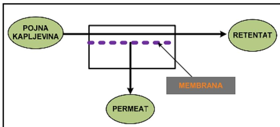
**Slika 11.** Osnovni princip membranskog razdvajanja.<sup>20</sup>
