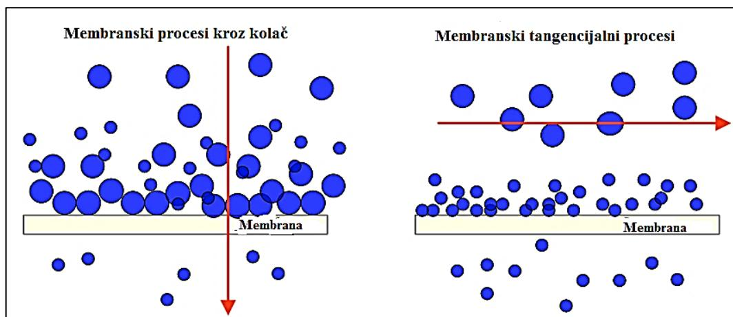
*Slika 12.* Membranski procesi s obzirom na način rada.<sup>22</sup>
