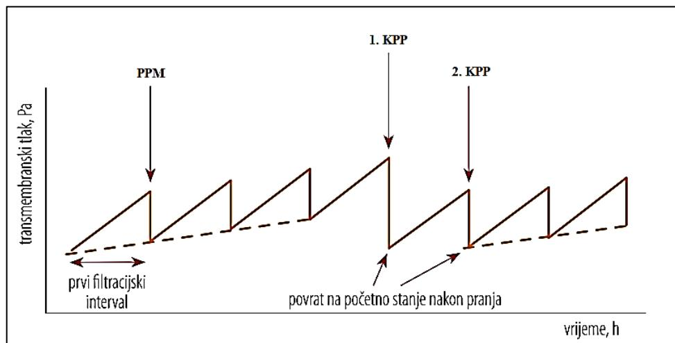
*Slika 32.* Promjena transmembranskog tlaka s vremenom i vrijeme pokretanja čišćenja UF membrane.<sup>35</sup>
