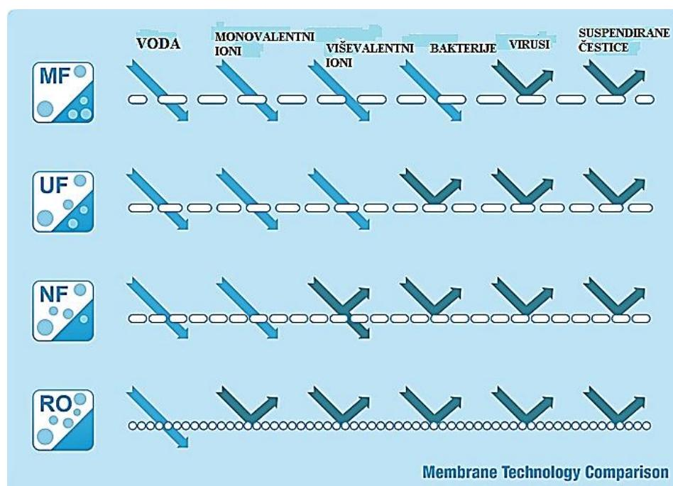
*Slika 17.* Djelotvornost membranskih filtracijskih postupaka.<sup>28</sup>
