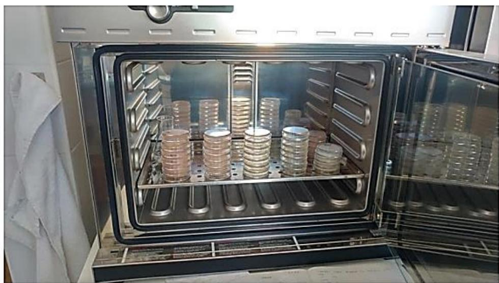
**Slika 21.** Termostatiranje uzoraka za određivanje koliformnih bakterija.
