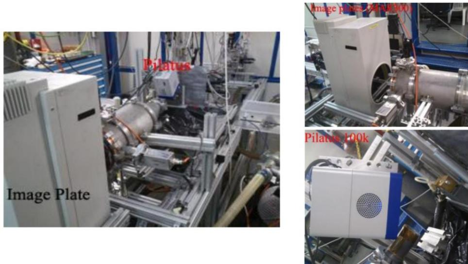
Slika 20. Eksperimentalni postav za prikupljanje SAXS i WAXS signala na SAXS liniji na sinkrotronu Elettra<sup>171</sup>
