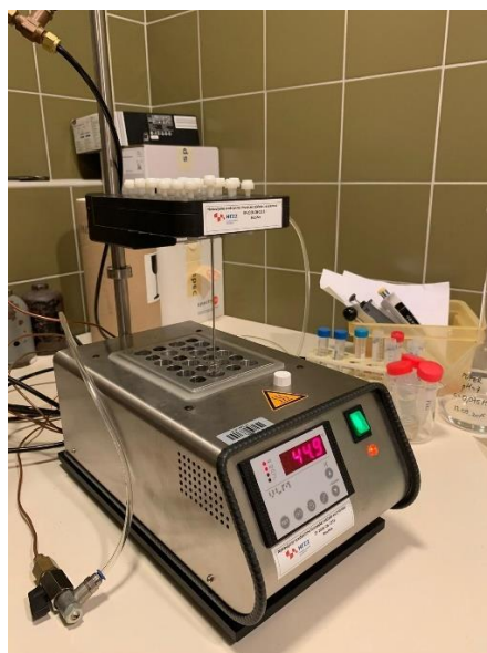
Slika 10. Uređaj za uparavanje uzoraka EC-1V-130 (VLM, Njemačka)
