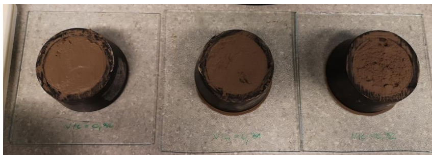
Slika 10. Pripremljene cementne paste, s lijeva na desno v/c=0,32-0,30
