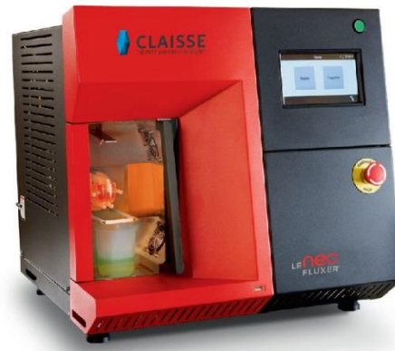
Slika 5. Postupak pripreve taljenih pastila za XRF analizu
